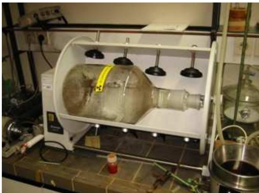
Abb. 3.4-1 Homogenisierung der Bodenproben
