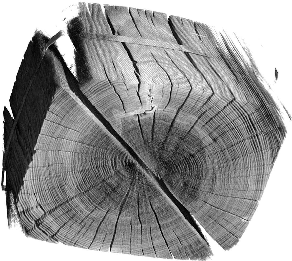
**Abbildung 114: BU166\_4T, Prüfkörperdarstellung mit Verwendung eines Filters der Software VGStudio 1.0. (Schwellenwert der dargestellten Graustufen = 600)**
