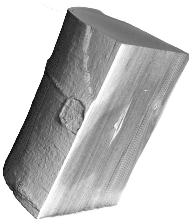
**Abbildung 97: BU57\_4T, Prüfkörper mit Mondkrater und erkennbare Verletzung im Holzkörper.**
