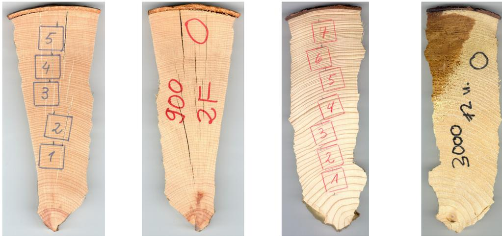
Abbildungen 7 - 8 - 9 -10: Schablonen für die Bestimmung der Lage der einzelnen Biegeprüfkörper im Rundholzabschnitt.
