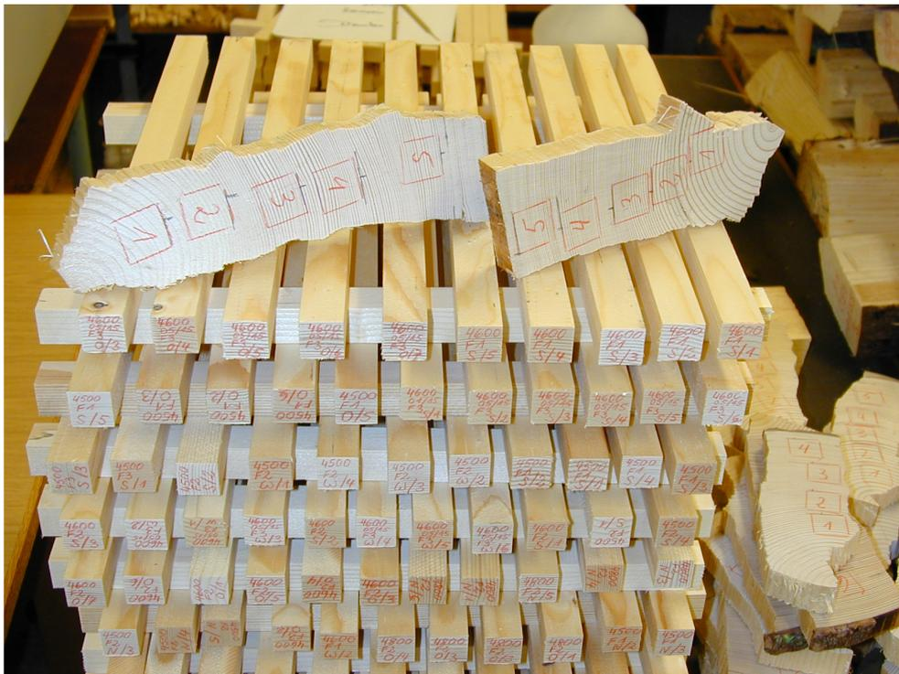
Abbildung 11: Ein Teil der ausgeformten fehlerfreien Biegeproben mit zwei Schablonen
