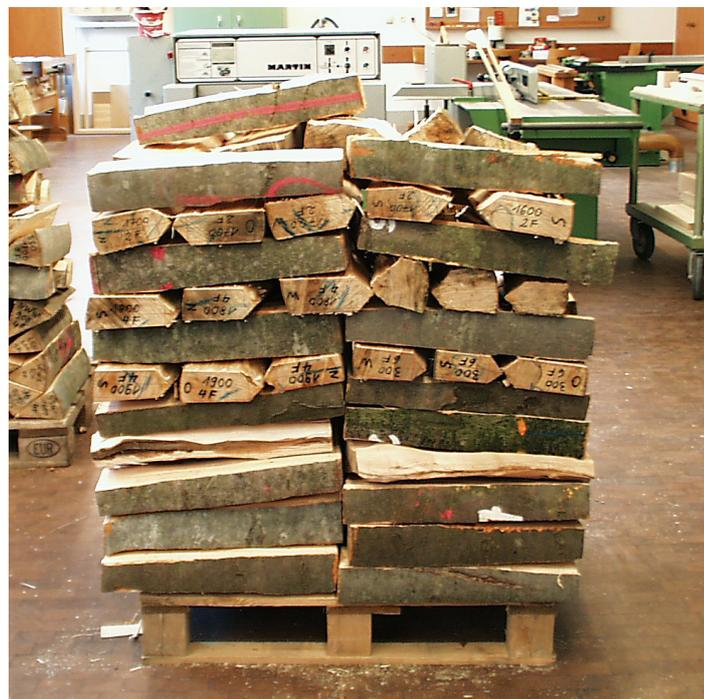
**Abbildung 6: Holzsplitter für die Ausformung von fehlerfreien Biegeproben**
