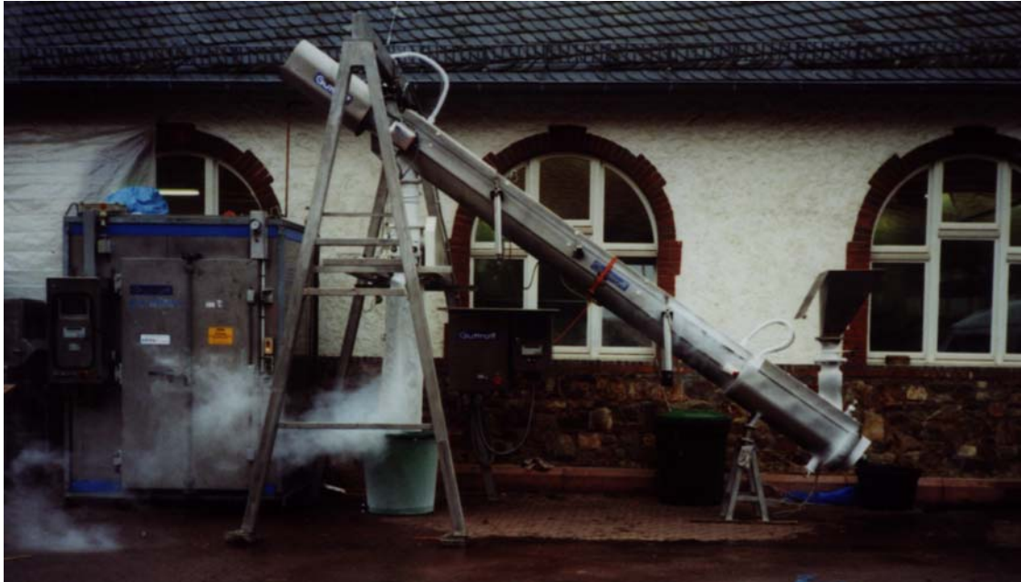
Abbildung 16: Schrägkühler und Kühlzelle
