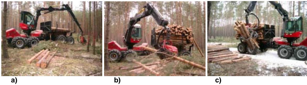
Abbildung 86 : KOMBIMASCHINE Valmet 801 beim a) Fällen b) Aufarbeitung c) Entladen
