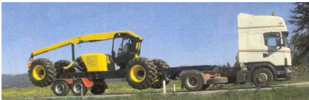
Abbildung 85 : Umsetzen eines Harvesters mit Standard-Sattelzugmaschine 3
