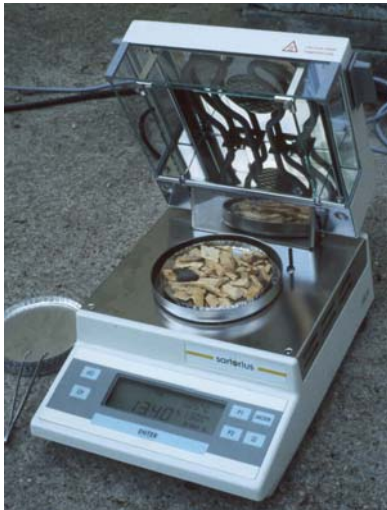
Abb. 16: Bestimmung des Wassergehaltes durch Infrarottrocknung (links: Fa. Sartorius, Typ MA 30; rechts: Fa. Ultra-X, Typ 2081)
