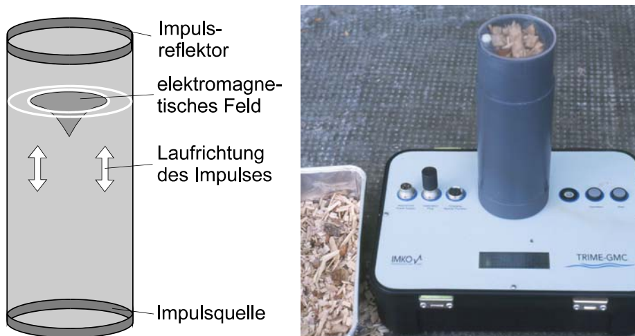
Abb. 23: TRIME-GMC Bechersonde mit Impulslauf (Fa. Imko)
