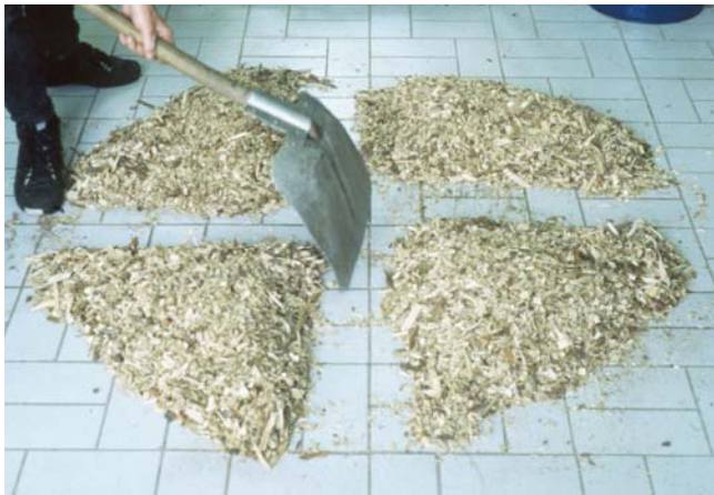
Abb. 55: Probenteilung nach dem Kegelfverfahren gemäß DIN 51701-3 [24]
