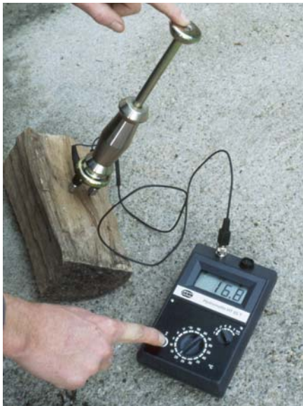
Abb. 24: Bestimmung des Wassergehaltes von Scheitholz nach dem Leitfähigkeitsverfahren mit einer Rammeelektrode (Fa. Gann)
