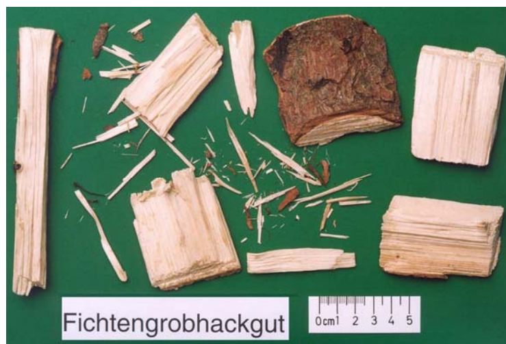
Abb. 44: Fichten-Grobhackgut, hergestellt mit einem Schneckenhacker (Fa. Sasmö)
