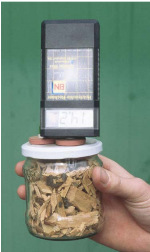
Abb. 28: Bestimmung des Wassergehaltes nach dem Luftfeuchte-Ausgleichsverfahren (Fa. Schaller)
