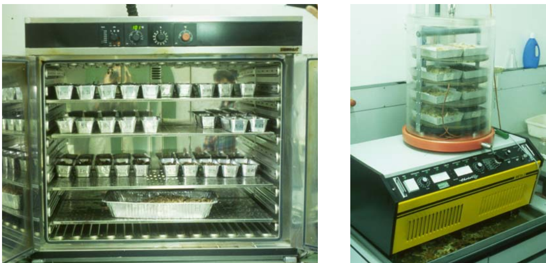
Abb. 15: Bestimmung des Wassergehaltes im Trockenschrank (links: Fa. Memmert, Typ ULM 700) und durch Gefriertrocknung (rechts: Fa. Christ, Typ Beta I)
