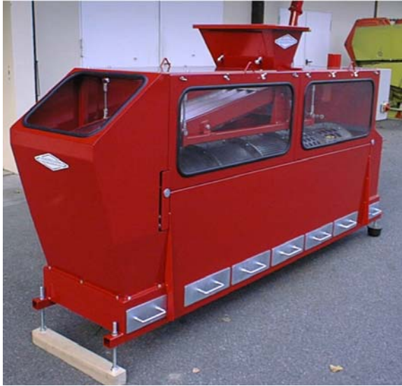
Abb. 47: Trommelsiebmaschine (funktionsgetreuer Nachbau eines Prototyps aus Dänemark [76]) 1
