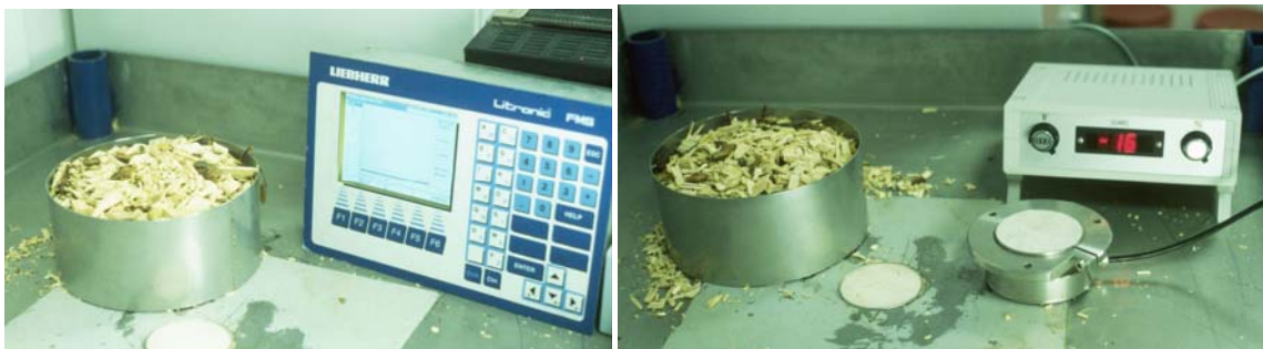
Abb. 20: Bestimmung des Wassergehaltes mit kapazitiven Verfahren für kontinuierliche Gutströme (links: Fa. Liebherr, Typ Litronic FMS; rechts: Fa. Arnold)
