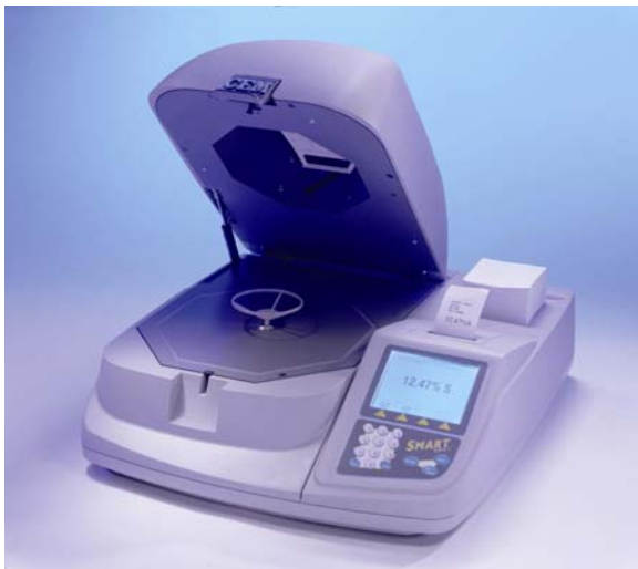
Abb. 17: Bestimmung des Wassergehaltes durch Mikrowellentrocknung (Fa. CEM, Typ Smart System 5)
