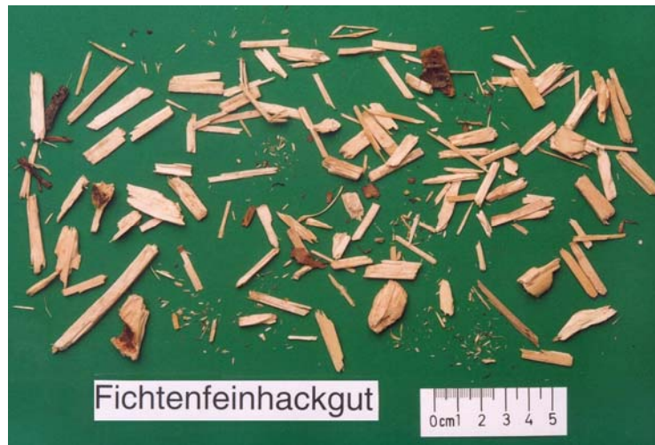
Abb. 42: Fichten-Feinhackgut G 30, hergestellt mit einem Trommelhacker (Sieb mit einem Quadratlochdurchmesser von 25 mm, niedrigste Einzugsgeschwindigkeit, Fa. Heizomat)
