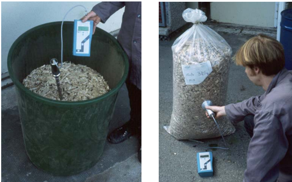
Abb. 22: Bestimmung des Wassergehaltes nach dem Mikrowellenverfahren mit einem tragbaren Einstechapplikator (links) und einer Messsonde (rechts)
