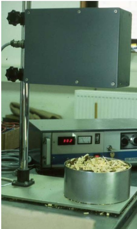
Abb. 27: Bestimmung des Wassergehaltes durch Infrarotreflektionsverfahren (Fa. Pier)
