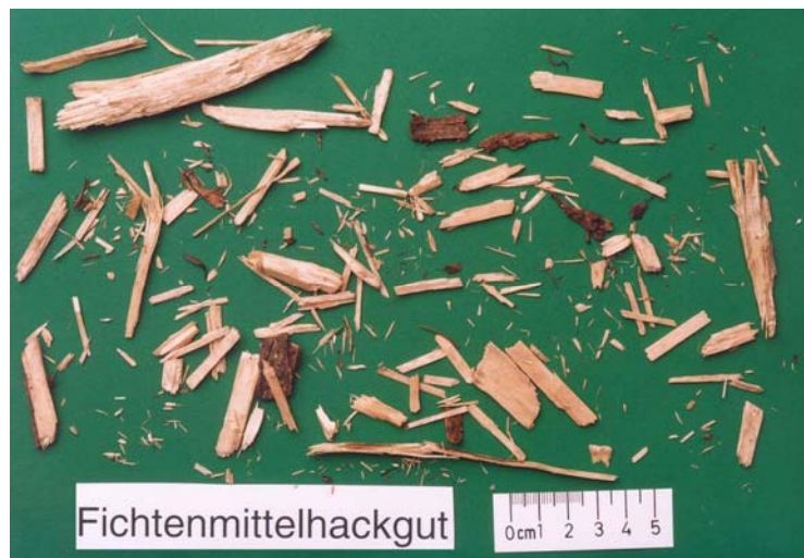
Abb. 43: Fichten-Mittelhackgut G 50, hergestellt mit einem Trommelhacker (Sieb mit einem Quadratlochdurchmesser von 58 mm, höchste Einzugsgeschwindigkeit, Fa. Heizomat)
