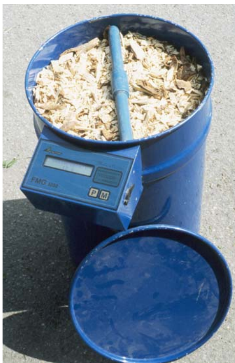
Abb. 18: Bestimmung des Wassergehaltes von Holzhackschnitzeln nach dem kapazitiven Verfahren (Fa. Pandis, Typ FMG 3000;)
