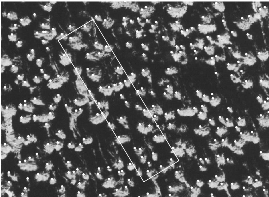
Abbildung 71: Das Schwarzweißbild der Referenzfläche 50. Das Polygon zeigt die Ausdehnung der Referenzfläche, die weißen Punkte die Baumpositionen, die mit Hilfe des Template Matchings erkannt wurden.
