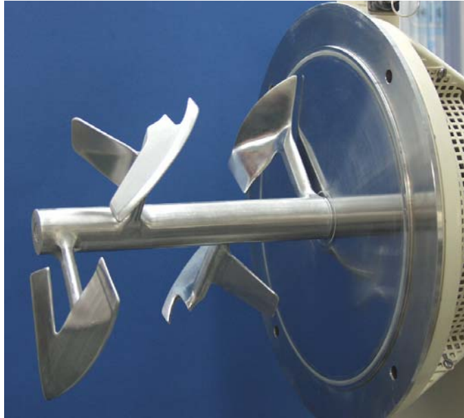
Fig. 4-97: Blades of the Lödige mixer M 20 MK used
