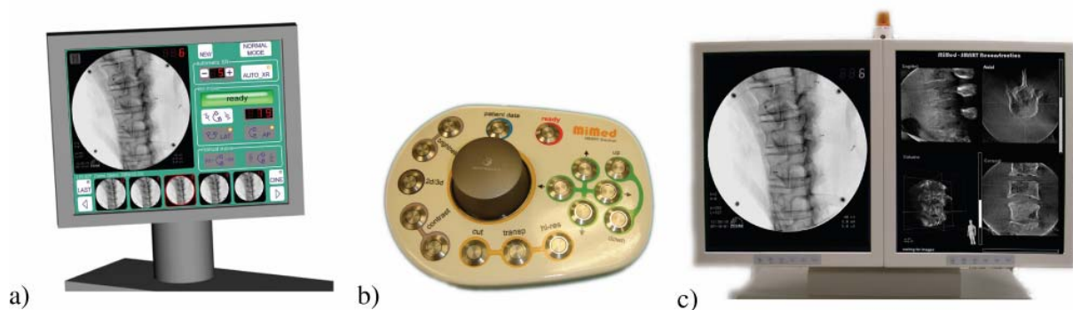
Bild 5-5: Die Mensch-Maschine-Schnittstelle des Systems. a) Ein an der C-Bogenmechanik montierter Touchscreen bildet die Schnittstelle zur isozentrischen Steuerung des Systems. b) Das 3D-Bedienpult bildet die Eingabeschnittstelle zur 3D-Visualisierung. c) Die Hochkontrastmonitore des Monitorwagens stellen sowohl die Röntgenprojektionen als auch die Volumendaten dar. (Alle Bilder © MiMed, 2006)
