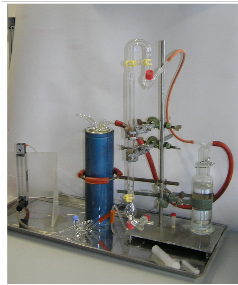
Abbildung A.1.: Fotografie der Zerschäumungsapparatur für pathologisches Hirnhomogenat
