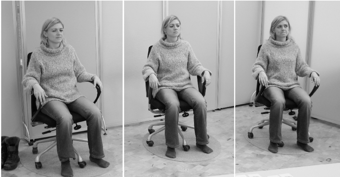
Abbildung 5-49: Handablagestrategie 2 – Kontakt der Hände mit der Armlehne, wenn dies durch leichte Rückverlagerung der Ellenbogen möglich ist. Sonst: Hängenlassen der Handgelenke. Links Stuhl 1, Mitte Stuhl 3, rechts Stuhl 2.
