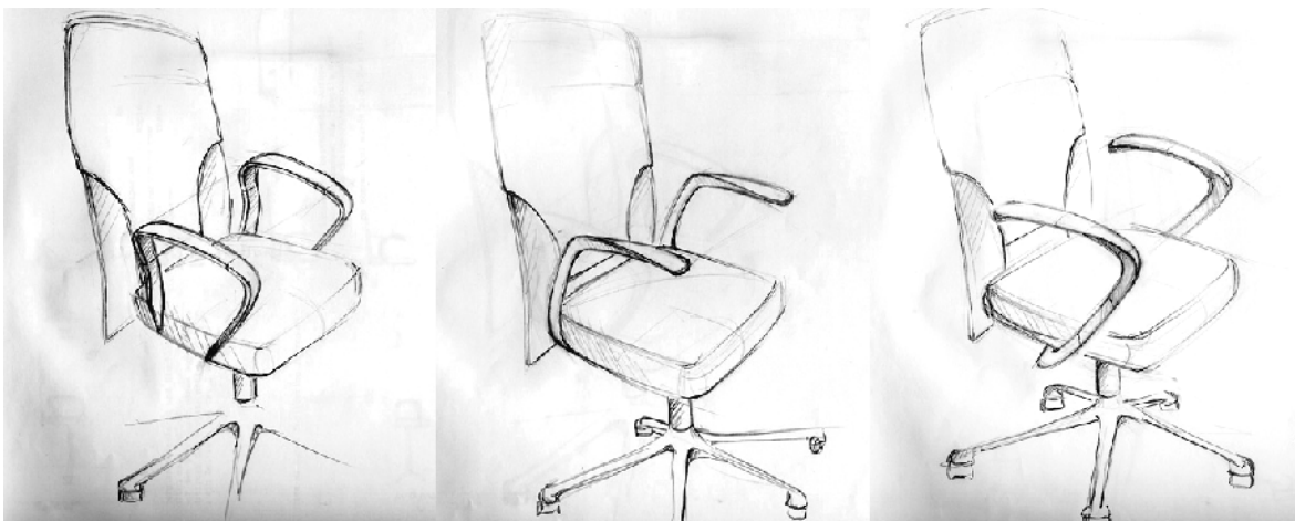
Abbildung 5-13: Weitere Ausarbeitung der Varianten mit besonderen haptischen Merkmalen in den drei Bauformen (allseits geschlossene, hinten geschlossene und vorne geschlossene Armlehnen. (Darstellung von Lilia Kleemann nach Vorgaben des Verfassers)
