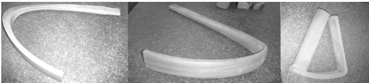
Abbildung 5-25: Ansichten der fertigen Gussmodelle: Variante 1, Variante 2 und Variante 3 (v.l.n.r.). Modellbau: Manfred Seib, Lilia Kleemann und der Verfasser.
