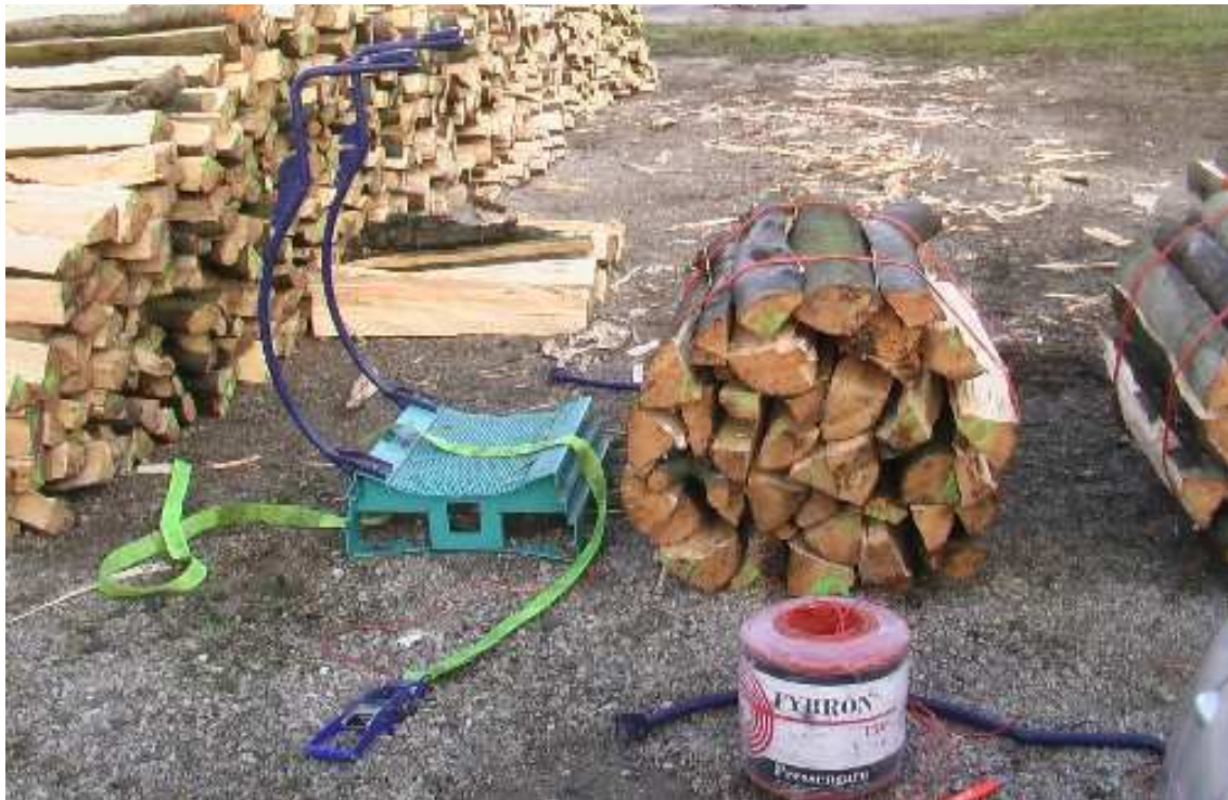
Abb. 65: Arbeitsplatzbeispiel für das Stapeln und Bündeln mit einer Bündelhilfe, hier für 0,5 Rm-Bündel
