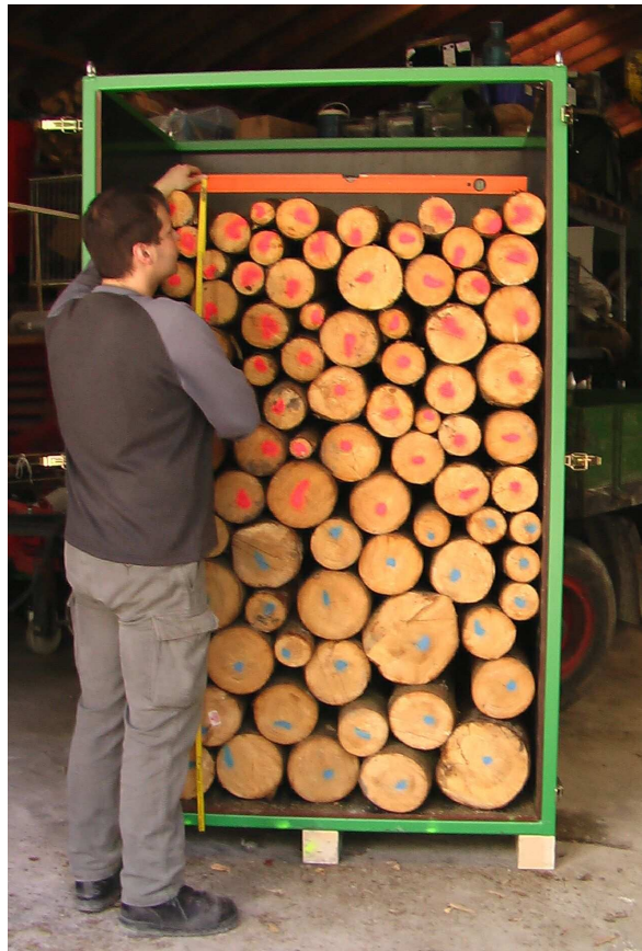
Abb. 16: Der Messrahmen für die Bestimmung der Scheitholz Raummaße
