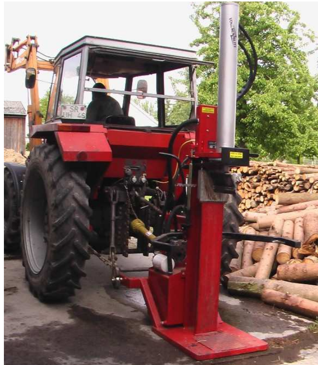
Abb. 45: Arbeitsplatzbeispiel für Zeitstudie zum Spalten mit großem Senkrechtspalter (hier: Spaltbrummi, Fa. Vogesenblitz)
