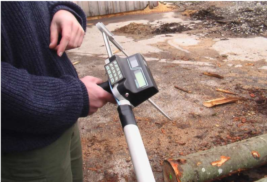
Abb. 9: Elektronische Kluppe für die Durchmesserbestimmung
