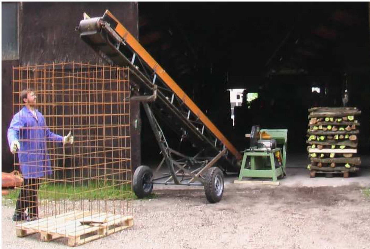
Abb. 18: Befüllen der Gitterbox für die Schüttevolumenbestimmung
