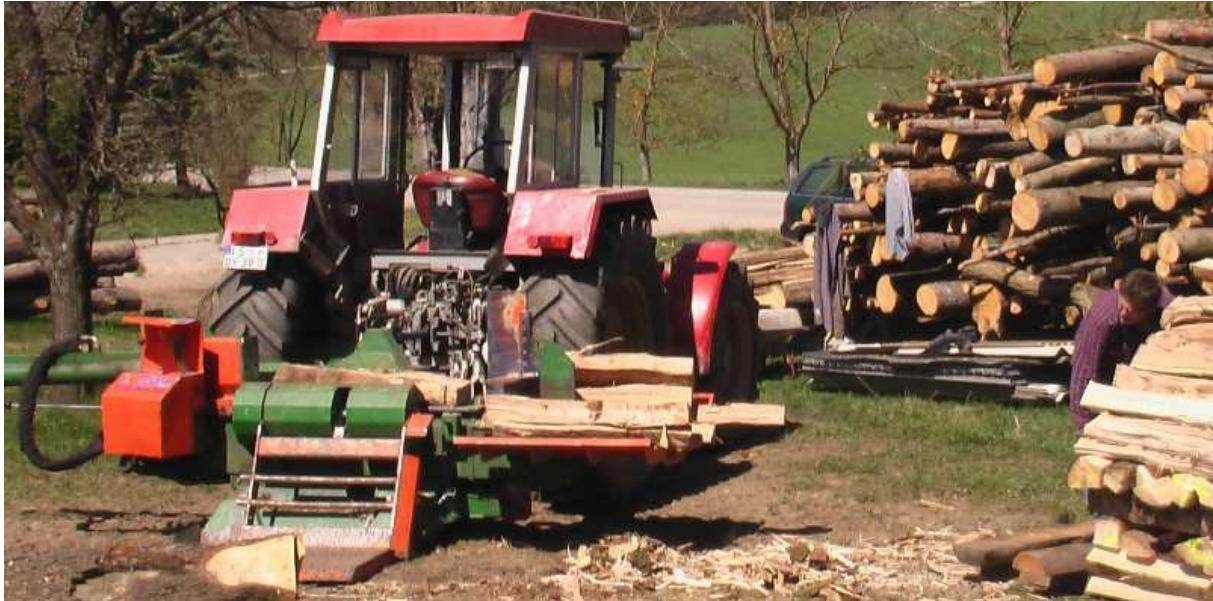
Abb. 50: Arbeitsplatzbeispiel für Zeitstudie zum Spalten mit großem Waagrechtspalter (hier: Hydromax 24 t, Fa. Posch)
