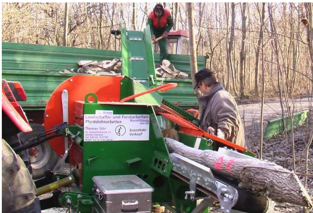
Abb. 55: Arbeitsplatzbeispiel für Zeitstudie zum Spalten mit der kleinen kombinierten Säge-Spaltmaschine (KK). Hier: Spaltfix 300, Fa. Posch
