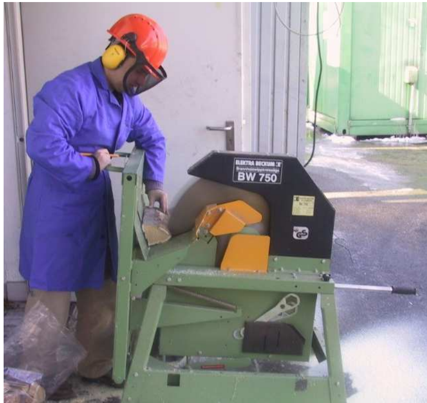
Abb. 23: Probenahme mit Kreissäge für Wassergehaltsbestimmung
