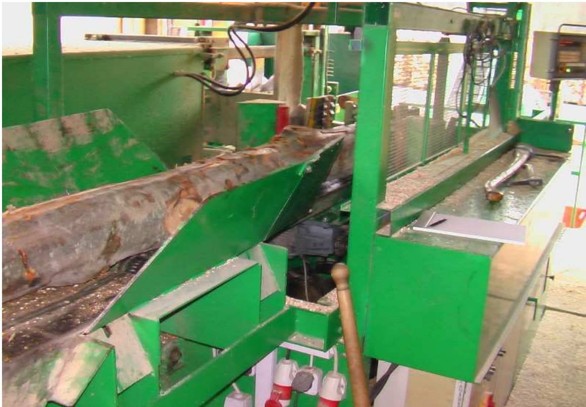
Abb. 59: Arbeitsplatzbeispiel für Zeitstudie zum Spalten mit der großen kombinierten Säge-Spaltmaschine (GK). Hier: Herkules II, Fa. Kretzer
