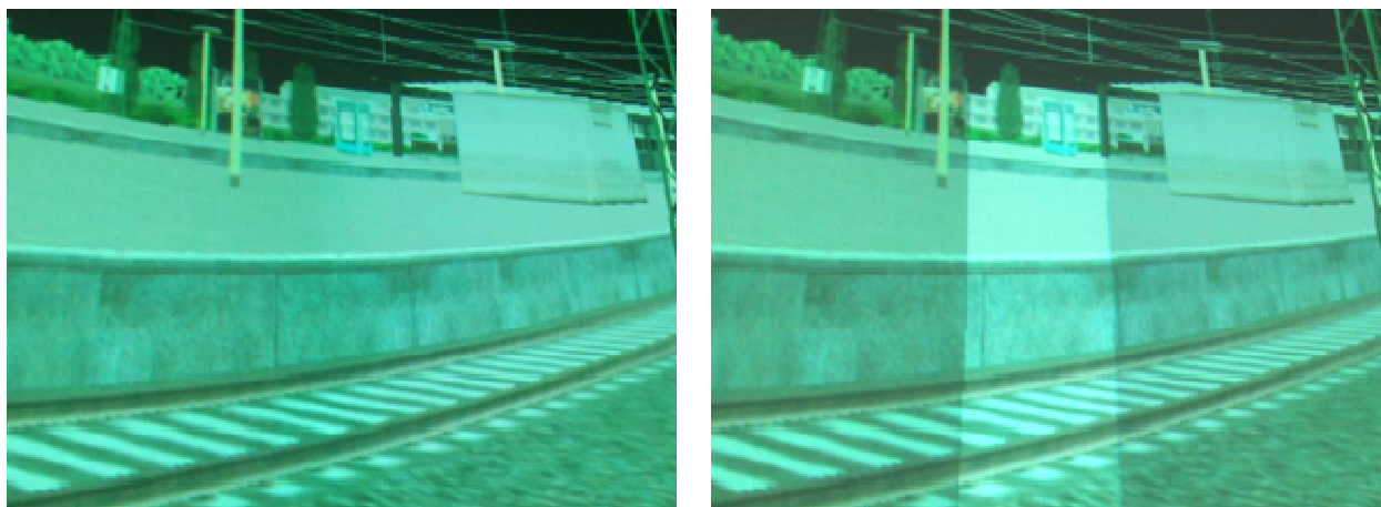
Abbildung 3-9: Frontprojektion am FTM-Simulator mit und ohne Edge-Blending. Im rechten Bild ist die Helligkeitsanpassung im Edge-Blending Bereich nicht aktiviert.
