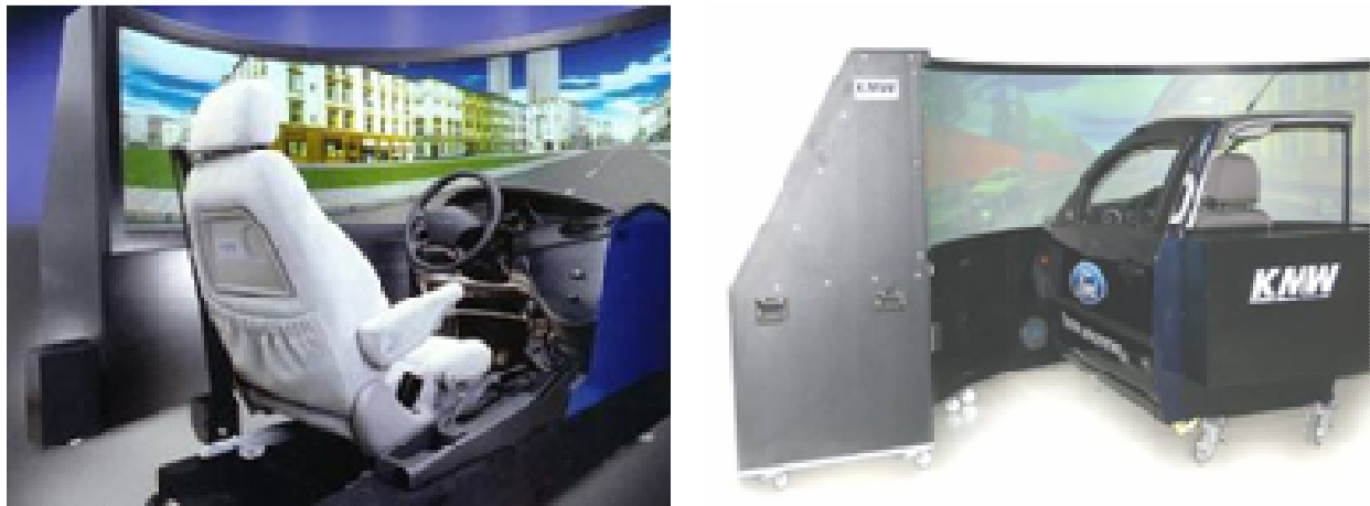
Abbildung 3-19: Ausführung des Mockups als Fahrstand (links), Teilfahrzeug (rechts) [KMW]
