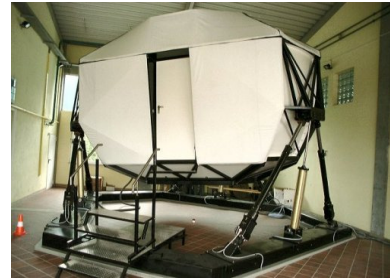
6 Freiheitsgrade Standard-BWS: • xyz-translatorisch • xyz-rotatorisch Universität Würzburg, Interdisziplinäres Zentrum für Verkehrswissenschaften
