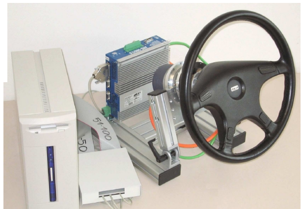
Abbildung 3-20: Ausführungsbeispiel einer Lenkmoment-Simulation - Senso-Wheel SD 17C von Sensodrive, (Maximalmoment: 26Nm, Feinfühligkeit: 0,03Nm, Bandbreite 30Hz, Taktrate: 1000Hz)
