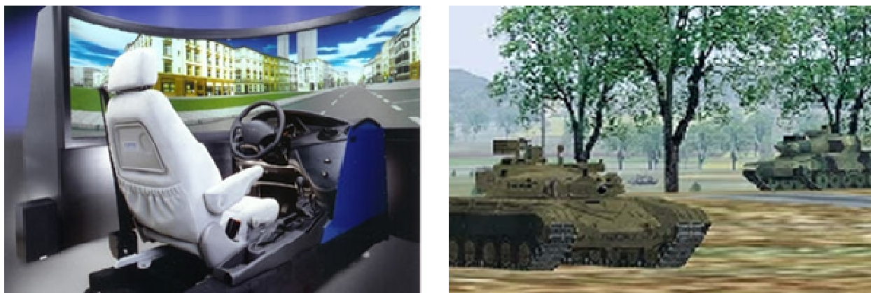
Abbildung 3-3: Fähigkeitserwerb – PKW-Fahrausbildung auf statischem Fahrsimulator und militärische Gefechtssimulation (Kraus-Maffei-Wegmann)
