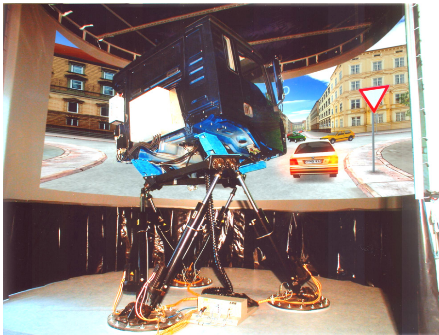
Abbildung 4-2: Der Projektionsraum des FTM-Simulators mit Standard-BWS und Sichtsimulation
