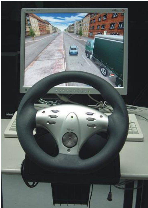
Abbildung 4-16: Steuerung des Sonderfahrzeugs am FTM-Simulator mit 1-Kanal Sichtsystem
