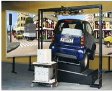
3 Freiheitsgrade • xy-rotatorisch: Neigeelemente • z-translatorisch: Hubelement • ungerichtete Vibrationselemente Dr.-Ing. Reiner Foerst GmbH
