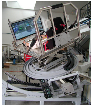
4 Freiheitsgrade • xy-rotatorisch: Neigeeinrichtung • z-rotatorisch: Drehtisch • z-translatorisch: Hubeinrichtung Universidad de Zaragoza
