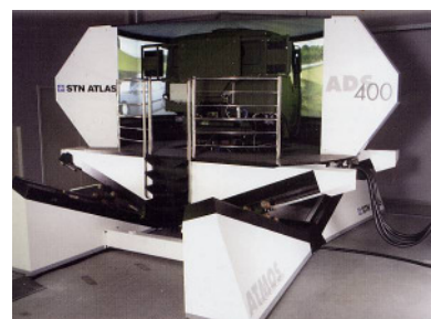
2 ½ Freiheitsgrade: • Rampen-BWS: BWS liefert kombinierte Rotation um die y-Achse bei Translation in x-Richtung und umgekehrt • ungerichtete Vibrationselemente STN Atlas Elektronik GmbH
