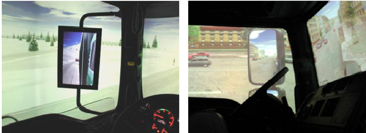
Abbildung 3-8: Rückspiegelansicht als LC-Display (links) und virtueller Rückspiegel (KMW, rechts)
