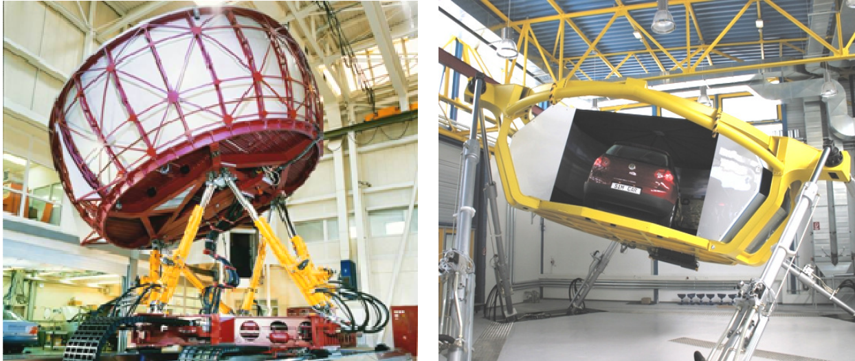
Abbildung 3-12: Flying-Screen Simulatoren in Aufsichtprojektion (links) und Rücklichtprojektion (Mitte), [Daimler-Chrysler, Berlin und DLR, Braunschweig]
