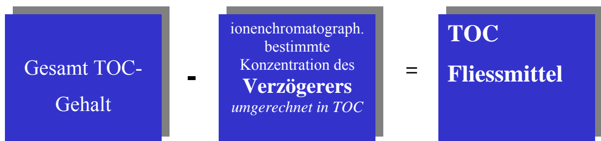
Abbildung 54: Schema zur parallelen Bestimmung von Verzögerern und Fließmitteln im Bindemittelleimfiltrat
