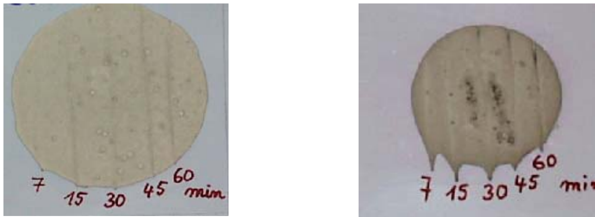
Abbildung 1: Messerschnitttest einer Selbstverlaufsmasse mit guten Selbstheilungseigenschaften (links) und schlechten Selbstheilungseigenschaften (rechts) [4].
