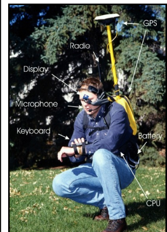
Abbildung 3-9: Beispiel WearComp mobiles GIS [HUNTER 2004]
