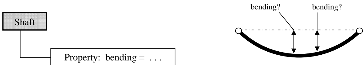
Bild 4-22: Unvollständige Beschreibung der Durchbiegung einer Welle
