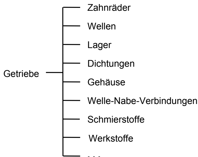
Bild 4-15: Vom Produktmodell berücksichtigte Getriebeelemente
