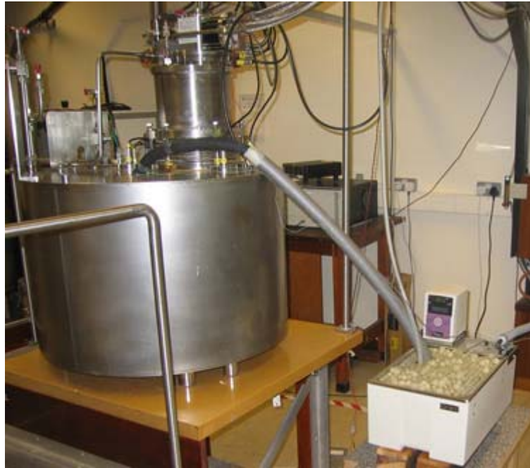
Abbildung 19 Temperierung des Magneten über Wasserbad
