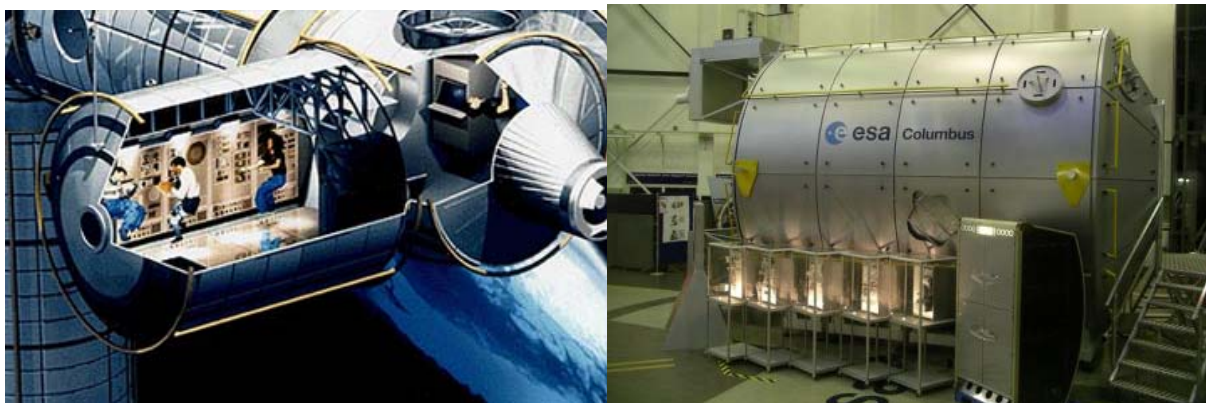
Abbildung 6 Das europäische Labormodul Columbus, schematische Darstellung (li) und Außenansicht des Modells von ESA/ESTEC in Noordwijk, NL; Fotos ESA
