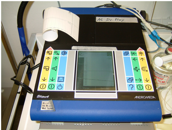
Abb. 22 Intrakavernöses Druckmessgerät (Andromeda Ellipse 4 (Taufkirchen)).
