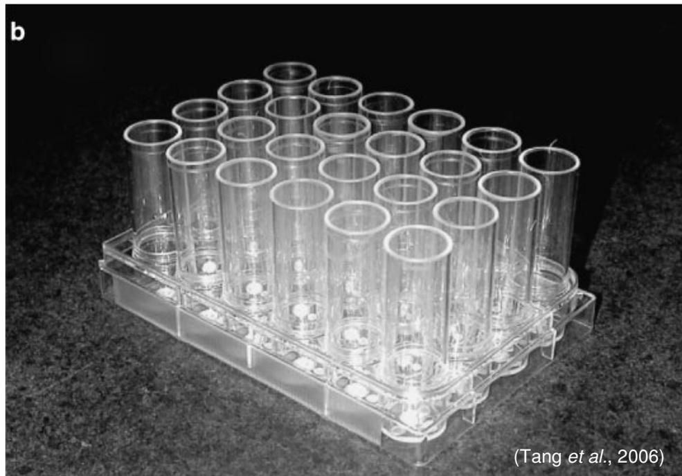
**Abbildung 3.1: 24-fache parallele Miniaturblasensäule**
