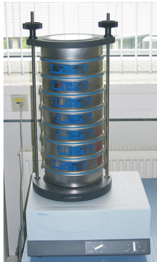
Abbildung 4-4: Schwingsiebmaschine zur Bestimmung der Korngrößenverteilung eines Schüttgutes
