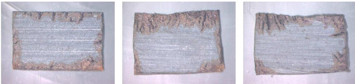
Abbildung 4.22: Schnittbilder der 35 Gew.-% Wollastonit-gefüllten Epoxidharzformulierung – TREMIN 283-100 (links), 939-100 (Mitte), 939-300 (rechts) nach 1500 h Lagerung bei 250 °C
