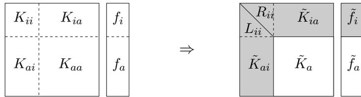
Abbildung 3.9: Block-Elimination der inneren Freiheitsgrade.
