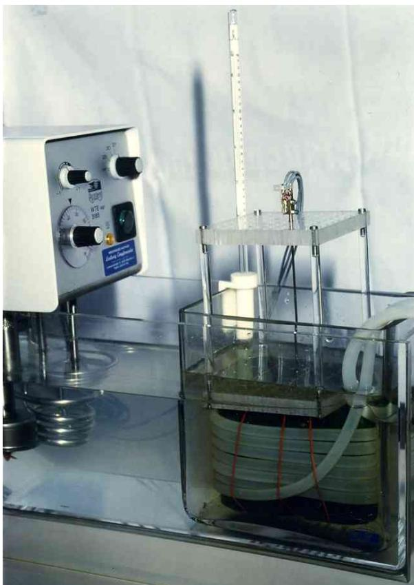
*Abb. 59: Versuchsaufbau für Messungen am Schwammphantom. Das Präzisionswasserbad links hält die Temperatur des Bades auf 37°C. Der Innenbehälter ist mit dem Elektrolyten gefüllt. Deutlich zu sehen der Schlauch um den Phantomschwamm, der vom Wasserbad mitversorgt wird. Der Abstandshalter aus Plexiglas sorgt für die reproduzierbare, parallele Positionierung der Nadelelektroden im 1 cm - Raster.*
