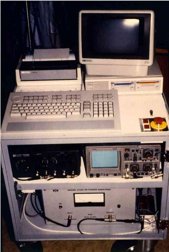
Abb. 22: Fahrbares IHS1-Überwärmungssystem. Oben der Steuerrechner, links daneben der Protokolldrucker, vorne rechts Hauptschalter und Not-Aus. Ganz unten der Leistungsgenerator mit der danebenliegenden HF-DC-Wandelschaltung zur Bestimmung der tatsächlichen RF-Ausgangsleistung. Bei Drücken des Not-Aus bleibt der, vom Patienten optoentkoppelte, GS-geprüfte Steuerrechner eingeschaltet. Behandlungsdaten gehen nicht verloren.
