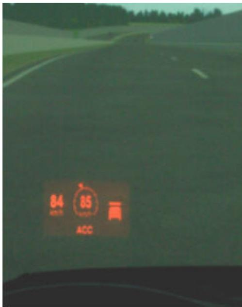
*Abbildung 3.2-2: Anzeige der Istgeschwindigkeit sowie der Rückmeldungen des ACC Systems im HUD*
