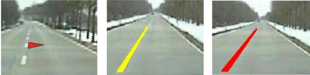
Abbildung 6.2-8: Die drei kontaktanalogen Varianten Dreieck, Linie gelb und Linie gelb-rot des Spurhalteassistenten
