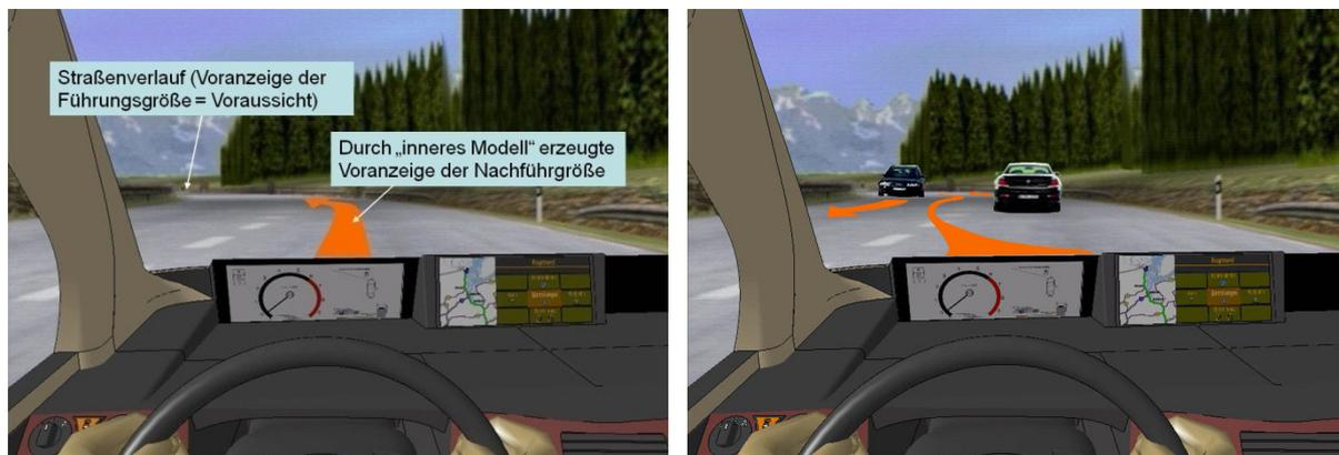
Abbildung 2.1-6: Zur Erfüllung der Querführung verwendete Voraussicht und innerlich generierte Voranzeige der Nachführgröße
