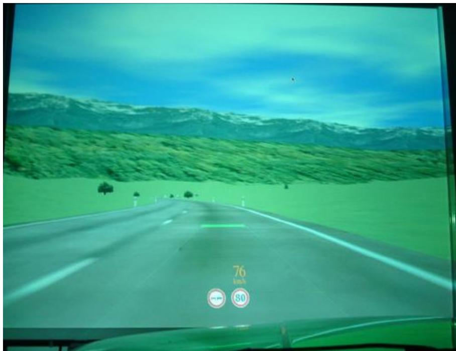
*Abbildung 3.1-2: Mit Hilfe von drei Beamern erzeugte Sicht des Fahrers mit dargestellter Datenbasis, kontaktanaloger Abstandshalteunterstützung und Verkehrszeichenassistent*
