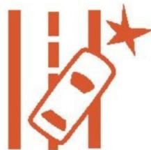
*Abbildung 6.2-7: Symbol für die Spurverlassenswarnung aus dem ISO 2575 Dokument*
