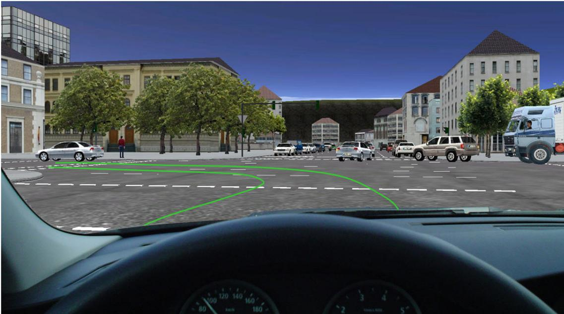
Abbildung 7-2: Beispiel für die kontaktanaloge Darstellung der Solltrajektorie für den Linksabbiegevorgang an einer Kreuzung
