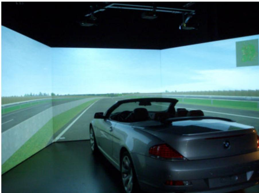
*Abbildung 3.2-1: Der 3-kanalige Fahrsimulator am Lehrstuhl für Ergonomie*
