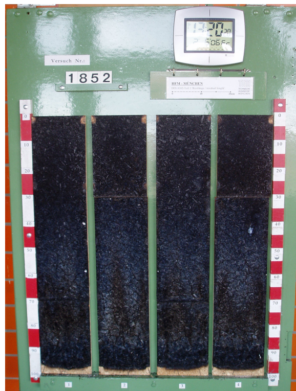
Abbildung 6-13: Spanplattenproben mit INB 710 nach der Prüfung im Brandschacht
