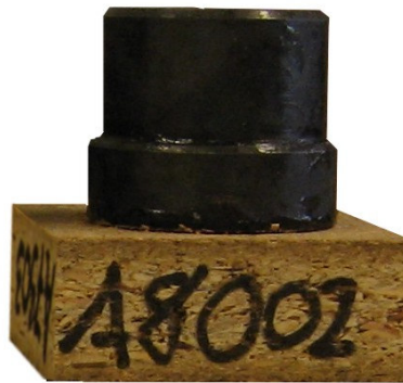
Abbildung 5-11: Abhebefestigkeitsprobe mit zentrisch aufgeklebtem Stahlpilz
