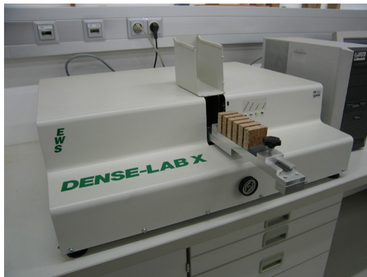
Abbildung 5-8: Dichtemessgerät der Fa. Electronic Wood Systems GmbH, Modell Denselab x (Treusch, 2007)
