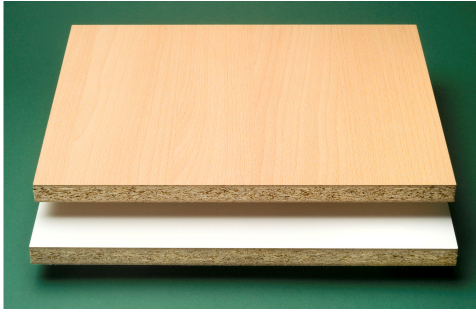
Abbildung 11-2: Weizenproteingebundene Spanplatten, beschichtet mit melaminharzgetränktem Papier
