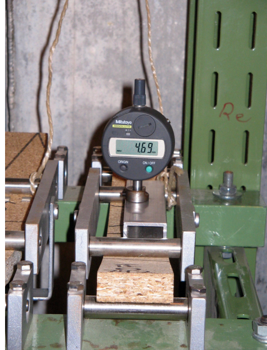
Abbildung 5-14: Messung der Durchbiegung mit einer elektronischen Messuhr
