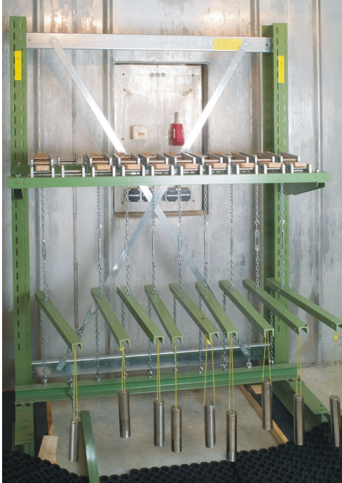
Abbildung 5-13: Prüfungsanordnung für die Kriechprüfung mit eingelegten Prüfkörpern (DIN EN 1156, 1999)
