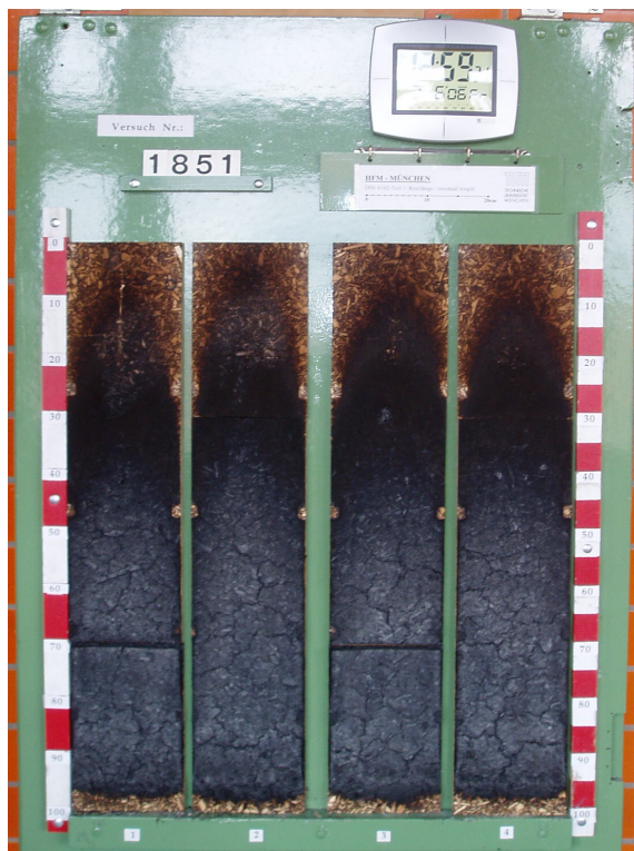
Abbildung 6-12: Spanplattenproben mit MD 915/315 nach der Prüfung im Brandschacht
