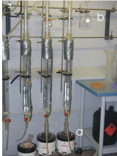
Abbildung 5-17: Apparatur zur Messung des Formaldehydgehalts mittels der Perforator-Methode, a) siedendes Toluol mit Proben, b) destilliertes Wasser mit Formaldehyd
