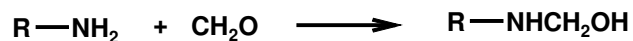
Abbildung 7-1: Reaktionsschema zwischen der Aminogruppe eines denaturierten Proteins (links) und Formaldehyd zu einem methylolisiertem Protein.
