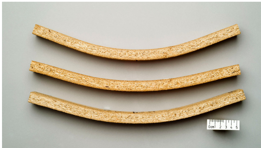
Abbildung 6-17: Durchbiegung von dreischichtigen proteingebundenen Spanplatten nach 111 Tagen Biegebelastung im Wechselklima 20 °C/85 % r.L. und 20 °C/30 % r.L.
