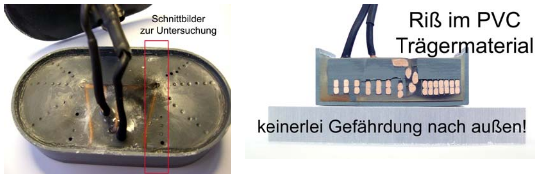
Abb. 4-67: Untersuchung des Spulenninneren: das Trägermaterial wurde Schicht für Schicht abgetragen.
