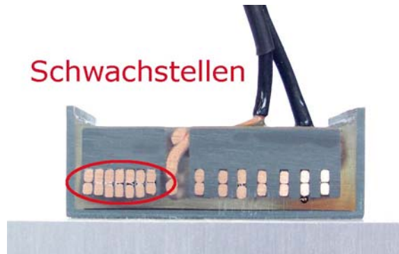
Abb. 4-69: Schwachstellen des ersten Prototypen: Die zwei Lagen liegen direkt übereinander – aufgrund der Konstruktion konnte auch kein Vergussharz eindringen.
