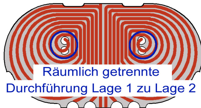
Abb. 4-72: Räumlich voneinander getrennte Durchführungen.
