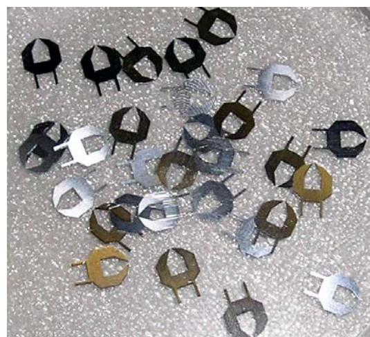
Abb. 4-33: Ausgestanzte Spulenkörper-Bleche mit 0,2mm breitem Luftspalt. Die zwei zusätzlichen dünnen Stegen dienen zur Stabilisierung der Leiterwicklungen.
