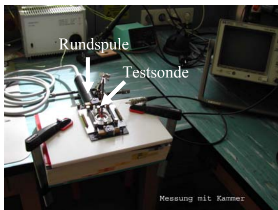
Abb. 4-11: Testsonde innerhalb der Kammer
