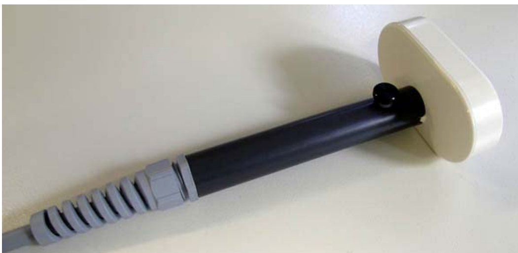
Abb. 4-90: Die Arrayspule, vier Spulen bilden das geforderte Spulenarray.
