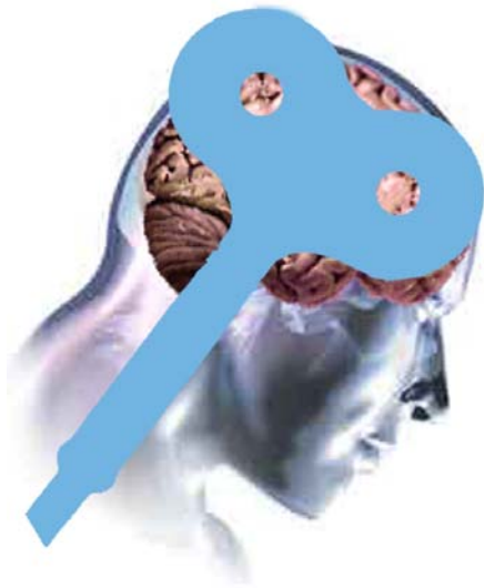
Abb. 4-39: Herkömmliche fokale Stimulationsspule; für die Stimulation zweier benachbarter Areale völlig ungeeignet.
