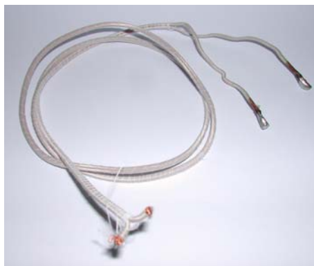
Abb. 4-80: Litzenprobe für die elektrische Prüfung
