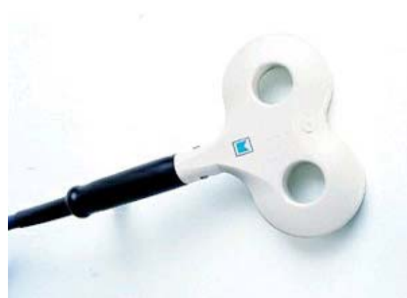
Abb. 1-6: Die Doppelspule wurde für die fokale Stimulation des Gehirns entwickelt. Die vom Strom gegenläufig durchflossenen Windungen bilden in der Spulnemitte ein Maximum.
