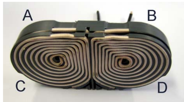
Abb. 4-83: Offene Version des Spulenkörpers, Prüfung der Spannungsfestigkeit der einzelnen Flügel und Lagen gegeneinander A, B, C, D
