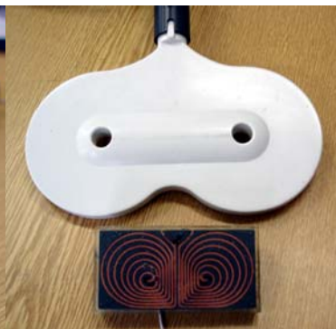
Abb. 4-61: Größenvergleich der kleinen Arrayspule und der herkömmlichen Doppelspule
