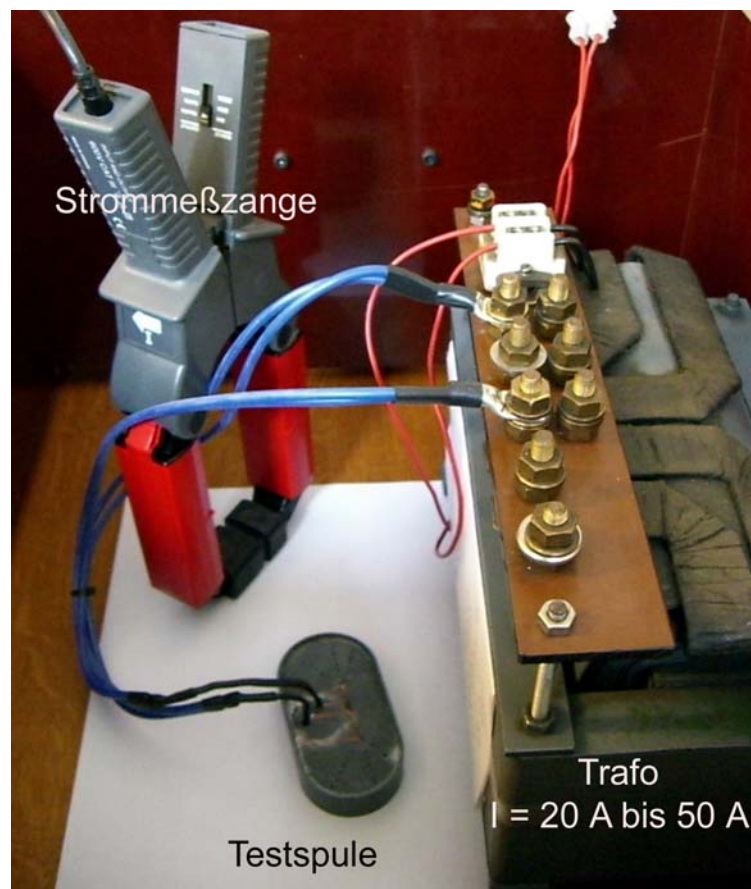
Abb. 4-70: Spule No.2 mit Anschlüssen für den Thermischen-Stress-Test
