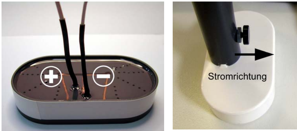
Abb. 4-78: Anschlussbelegung der Hf-Litze (links abgebildet ist der erste Prototyp, die Anschlussbelegung wurde jedoch beibehalten).
