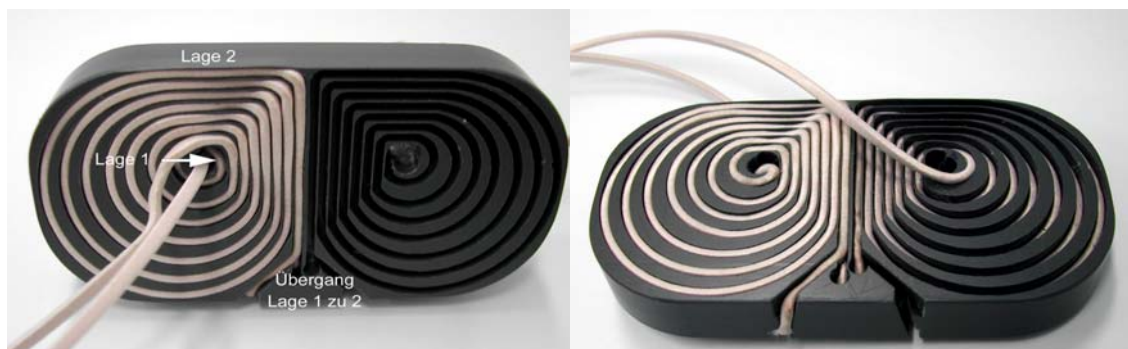
Abb. 4-59: Zweilagige Wicklung des PVC Spulenkörpers
