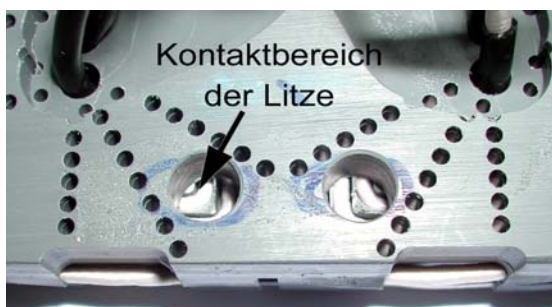
Abb. 4-76: Position der Temperatursensoren.
