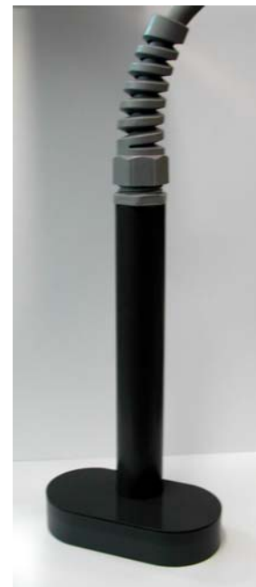
Abb. 4-65: Fertiggestellter Prototyp im PVC Gehäuse mit Stempelgriff
