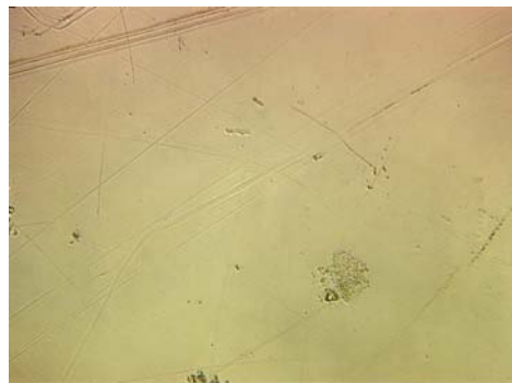
Kaltgewalzter Edelstahl elektroliert ( R_a = 0,12 \mu\text{m} )
