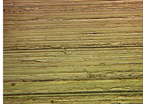
Edelstahl K 400 ( R_a = 0,57 \mu\text{m} )
