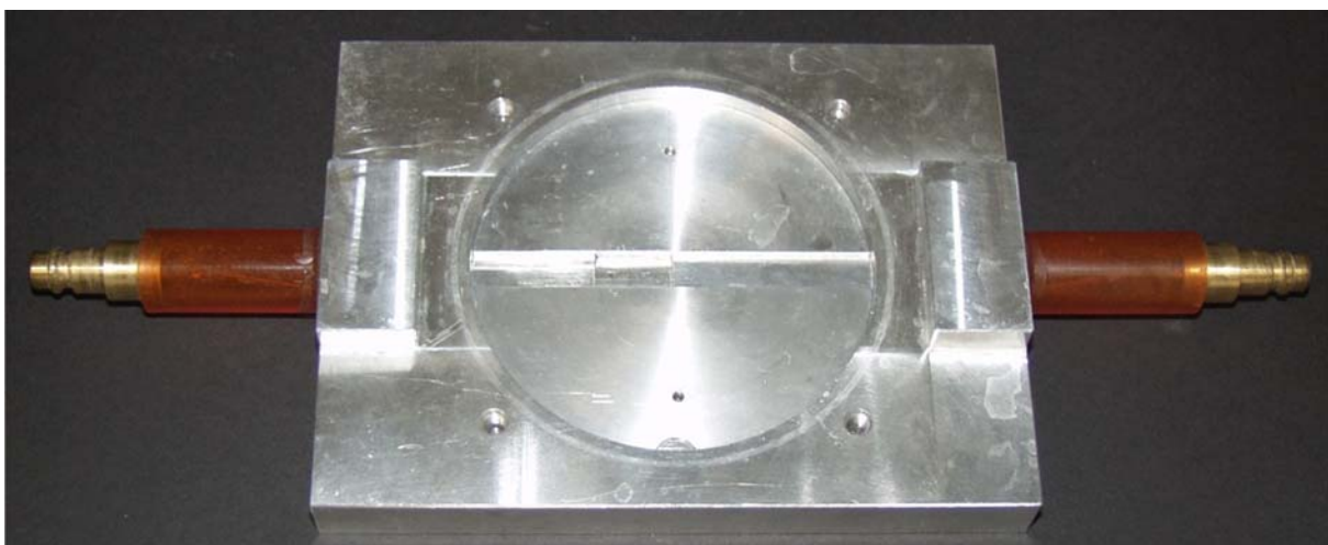
Abbildung 4.15: Gehäuse und Kanal-Platten der Strömungszelle mit Zustromdüsen (ohne Deckel)
