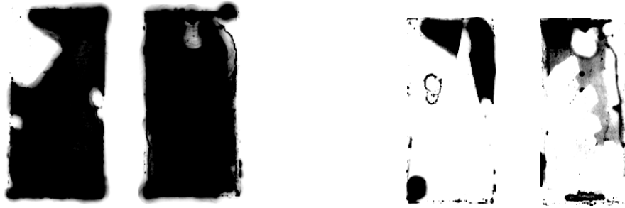
Abbildung 4.17: Bilder der verschmutzten Werkstoffoberflächen (10 × 20 mm) aufgenommen von dem Fluoreszenzscanner vor (links) und nach der Reinigung (rechts).
