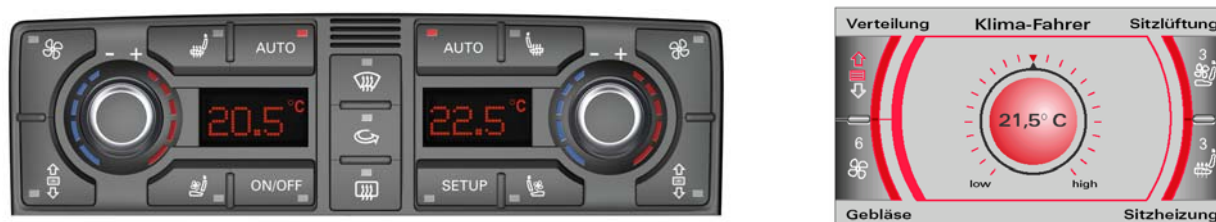
Abbildung 3.31: Klimavollautomat Audi A8; rechts Anzeige im MMI-Display (Quelle AUDI AG)
