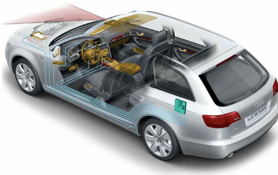
Abbildung 2.7: Aufbau Versuchsfahrzeuge. Gelbe Markierung: Protokollierte Funktionen Grüne Markierung: Datenkanäle und –speicherung Rote Markierung: Kamerawinkel (nur bei einem Versuchsfahrzeug)
