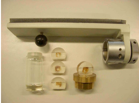
Abb. 3 Einbettgläschen, zugeschnittene Zylinder, aufgeklebte Probe und Halterung der Innenlochsäge
