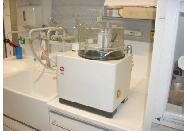
Abb. 4 Innenlochsäge Leica® SP1600
