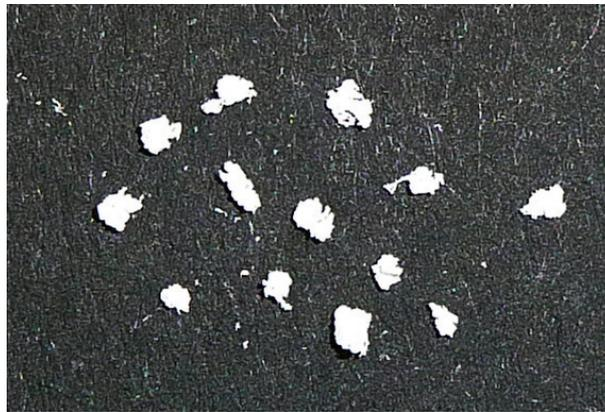
**Abbildung 72:** *Polyethylenpartikel aus den Horizontalautoklavexperimenten*
