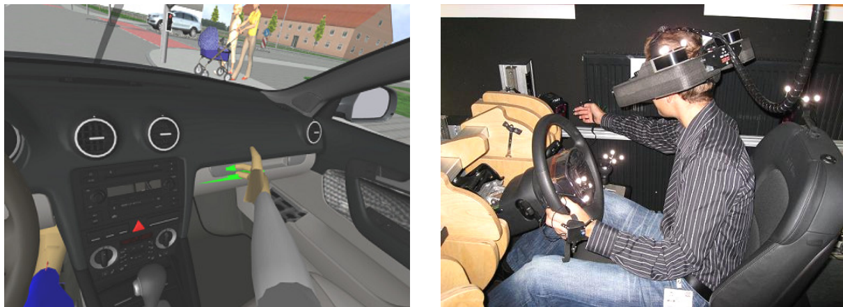
Abbildung 26: Bewertung „Erreichbarkeit Handschuhkastenöffner“ im virtuellen Fahrzeugmodell (links die Sicht der Versuchsperson in virtueller Umgebung, rechts das Verhalten der Versuchsperson in realer Umgebung).
