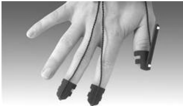
Abbildung 10: Datenhandschuh der Firma A.R.T. mit drei getrackten Fingern (A.R.T., 2007a).
