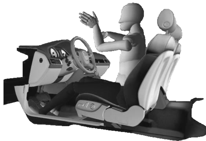
Abbildung 11: RAMSIS-VR in einem virtuellen Fahrzeugmodell.
