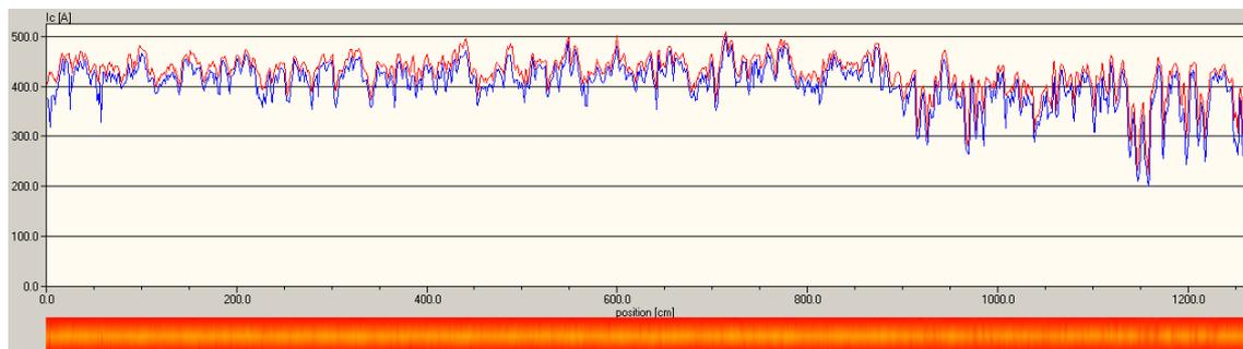
Abbildung 4.85: Hallsonden-Messung eines rund 13.5 m langen HTS-Bandleiters, dessen ISD-Beschichtung am 24.5.2006 durchgeführt worden ist
