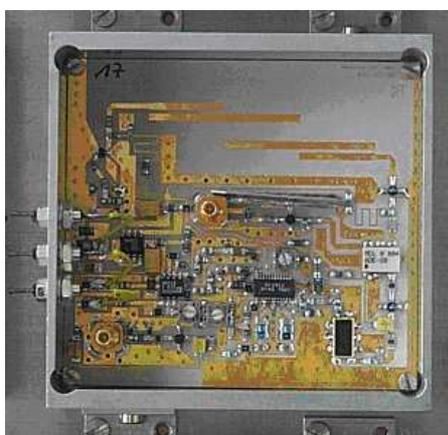
**Abb. 3.18:** Einzelnes Empfängermodul
