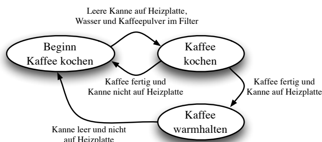
Abbildung 2.10.: Stark vereinfachter Zustandsautomat der Kaffeemaschine.
