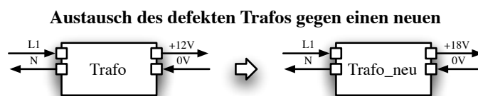
Abbildung 1.32.: Austausch eines defekten Subsystems (Trafo) aus der Kaffeemaschine gegen ein neues.
