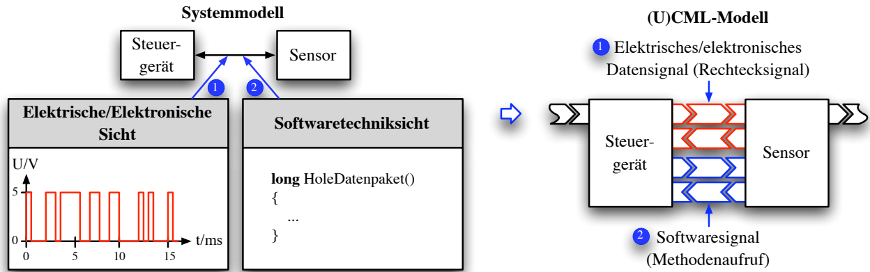
Abbildung 3.165.: Übertragung eines oder mehrerer Softwaretechniksignale über eine dezidierte elektrische/elektronische Verbindung.
