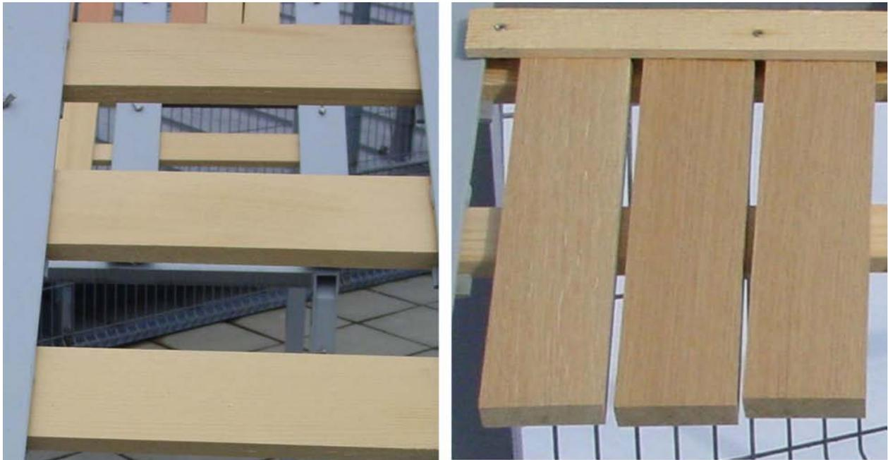
Abbildung 3.3: Darstellung der unterschiedlichen Versuchsanordnung der Proben in der Freibewitterung, links: quer zur Falllinie und rechts: parallel der Falllinie
