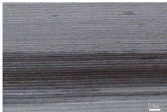
Abbildung 4.56: Tannenprobe mit oberflächlichem Abtrocknungsprozess, wobei ein Streifen noch feucht ist und als dunkler Streifen wahrgenommen wird
