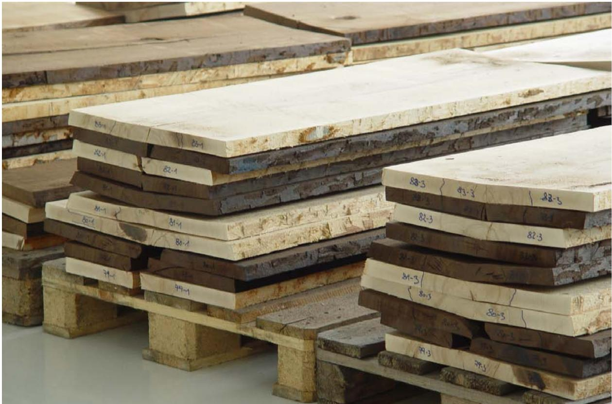
Abbildung 1.2: Farbunterschiede bei unbehandelten und wärmebehandelten Buchenbohlen
