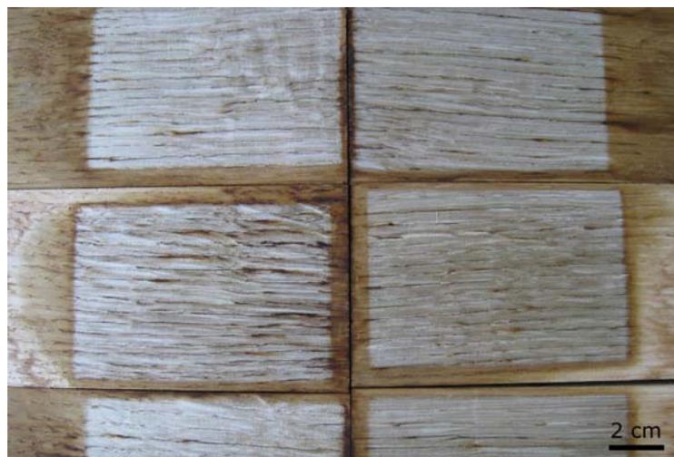
Abbildung 4.69: Visuelle Betrachtung der bewitterten Eichenoberflächen nach 1661 Stunden Prüfdauer
