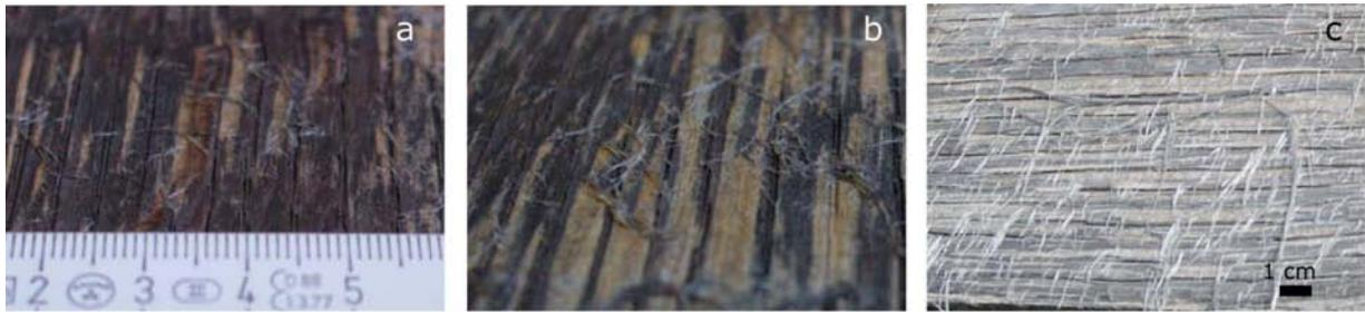
Abbildung 4.45: Makroskopische Aufnahmen des Faserabtrags an Eichenproben
