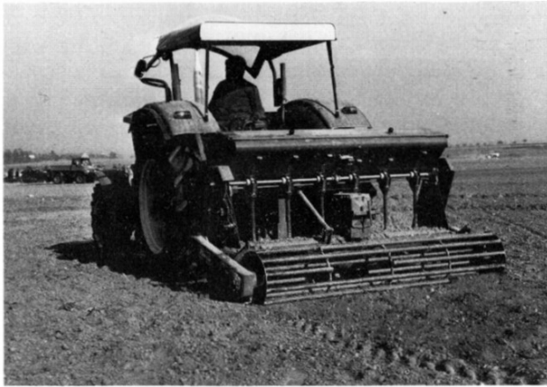
Abb. 1: Kreiseleggen lassen sich für die Breitsaat und bei Ablage des Saatgutes durch normale Drillschare auch für die Drillsaat nach einer Pflugfurche verwenden.
