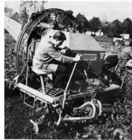
Bild 1: Der Futterrüben-Köpfröder der Fa. Kemper war als erster auf dem Markt. Die Rüben werden von einem umlaufenden Hubrad in den Sammelbunker gefördert.
