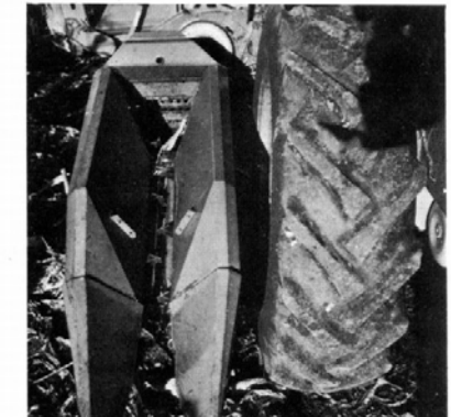
Bild 7: Spezial-Anbau-Pflückhäcksler als Neukonstruktion für die Maiskolbenernte. Vergl. Bild 4, Verfahren 1, Firma Mengele. Bild 8: Spezial-Anbau-Pflückhäcksler als Neukonstruktion für die Maiskolbenernte. Vergl. Bild 4: Verfahren 1, Firma Pöttinger.
