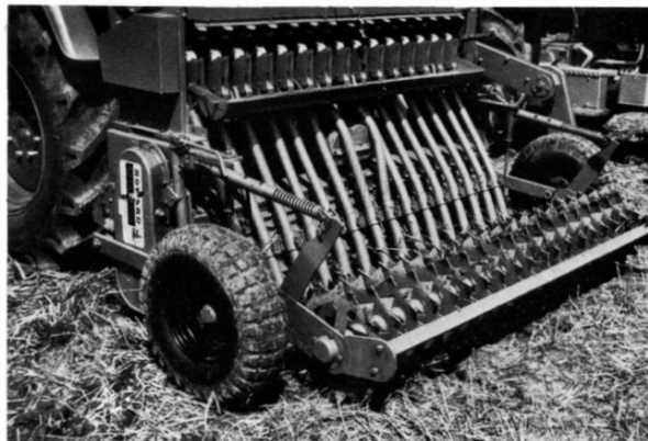
Abb. 8: Der gefräste Boden wird durch Packerwalzen mechanisch verdichtet. Z. T. stützt sich die gesamte Maschine auf die Walze ab und wird dadurch exakt in der Arbeitstiefe geführt.
