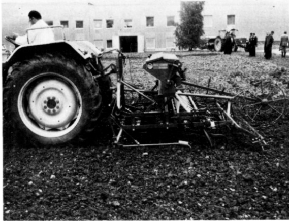
Abb. 4: Bei Feingrubbern wird das Saatgut in die Zinkenfurche abgelegt. Verstellbare Saatausläufe erlauben das Verändern der Ablage-tiefe.
