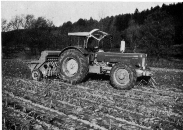
Abb. 7: Frässaat mit Saatgutablage vor der Fräswelle auf abgerentem Silomaisfeld. Für 2,5 m Arbeitsbreite sind ca. 100 PS erforderlich.
