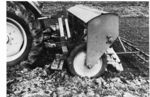
Abb. 3: Bei dieser Kombination von Rüttellegge und Drillmaschine sind die Geräte an den Dreipunkt-Anlenkungen gekoppelt.
