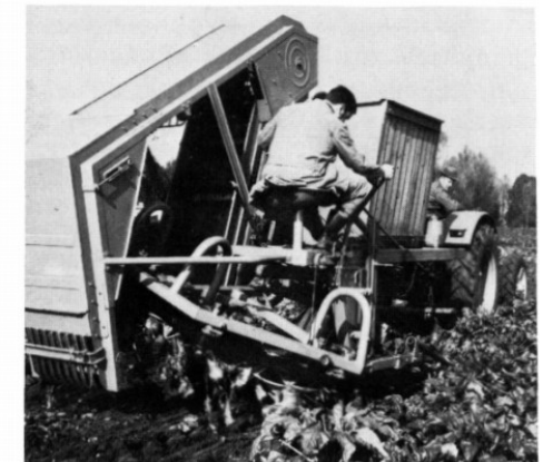
Bild 4: Fa. Fähse hat für ihre Maschine den hydraulischen Antrieb gewählt. Der durch Kippen zu entleernde Bunker wird von hinten durch einen Elevator befüllt.
