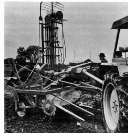
Bild 7: Der Wagenröder der Fa. Lengerich ist anstelle eines Bunkers mit einem zur Seite auslegbaren Ladeelevators ausgerüstet.
