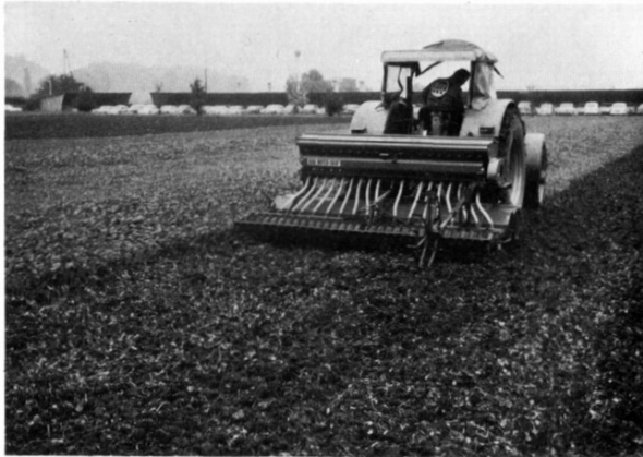
Abb. 6: Beim Einmulchen von Zwischenfrüchten kann gleichzeitig die Wintersaat eingebracht werden.
