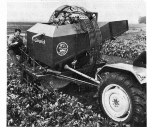
Bild 1: Der Futterrüben-Köpfröder der Fa. Kemper war als erster auf dem Markt. Die Rüben werden von einem umlaufenden Hubrad in den Sammelbunker gefördert.
