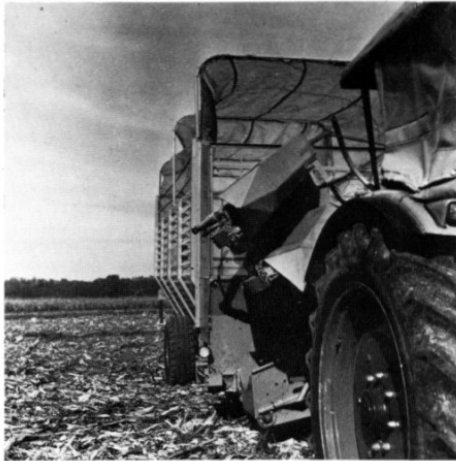
Bild 9 a: In Transportstellung. Häckslerladerwagen mit Pflückvorsatz für die Maiskolben-ernte. Vergl. Bild 4, Verfahren 3.
