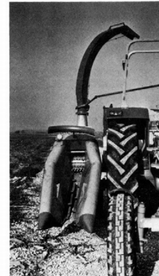
Bild 7: Spezial-Anbau-Pflückhäcksler als Neukonstruktion für die Maiskolbenernte. Vergl. Bild 4, Verfahren 1, Firma Mengele. Bild 8: Spezial-Anbau-Pflückhäcksler als Neukonstruktion für die Maiskolbenernte. Vergl. Bild 4: Verfahren 1, Firma Pöttinger.
