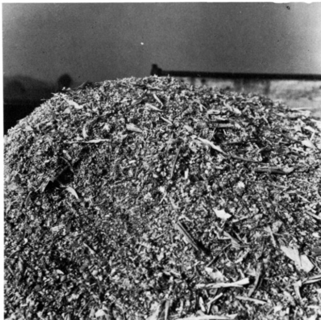
Bild 10: Maiskolbenschrot von Spezial-Anbau-Pflückhäckslern. Rohfaseranteil je nach Arbeitsgeschwindigkeit, Feldbestand, Reifegrad und Konstruktion 9-15%.
