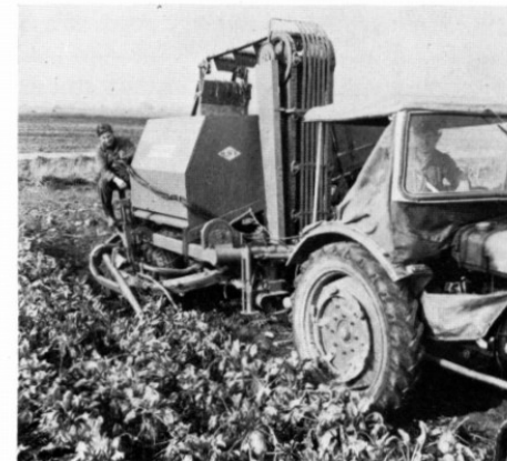
Bild 4: Fa. Fähse hat für ihre Maschine den hydraulischen Antrieb gewählt. Der durch Kippen zu entleernde Bunker wird von hinten durch einen Elevator befüllt.
