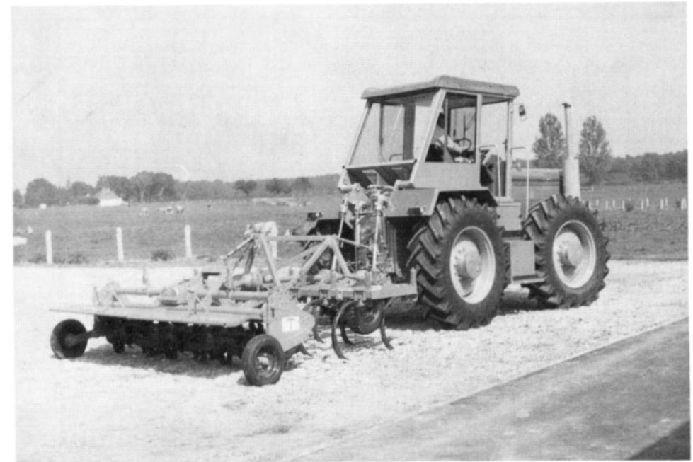
Abb. 14. Die Kombination von Bodenfräse und Schwergrubber leistet bei der Stroheinmischung den besten Effekt bei gleichzeitig relativ geringem Leistungsbedarf
