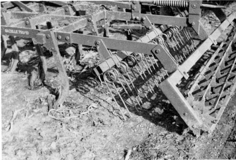
Abb. 9. Eine häufig verwendete Kombination von Nachläufern: Federzinkenrechen (u.U. mit abgewinkelten Werkzeugen) zum Einebnen, Krümelwalze zum Krümeln und Verdichten
