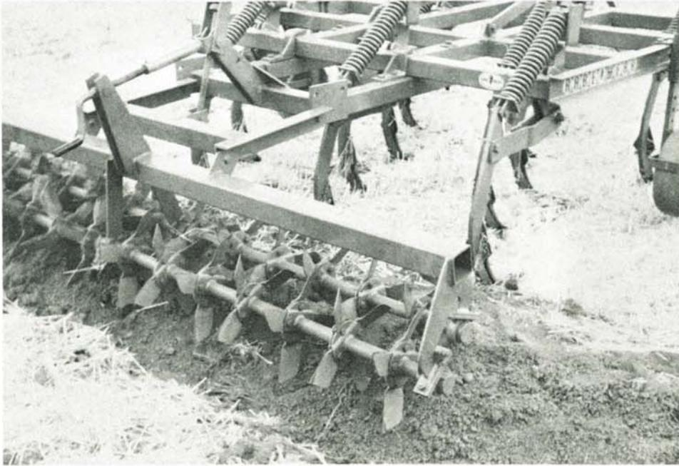
Abb. 11. Die Spatenrolle mit zwei Messerwellen soll die Einmischung des Strohs in den Boden unterstützen. Eine Anstellung der Messerwellen schräg zur Fahrtrichtung verbessert die Wirkung
