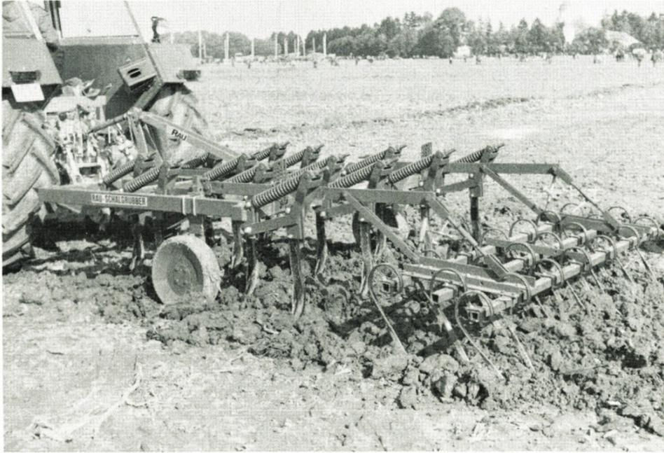
Abb. 7. Federzinken in mehrreihiger Anordnung sollen gleichzeitig einebnen und krümeln
