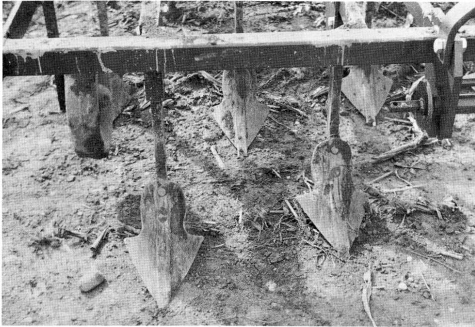
Abb. 3. Gänsefuß-Breitschare mit ca. 250 mm Schnittbreite werden für die flache Stoppelbearbeitung bevorzugt
