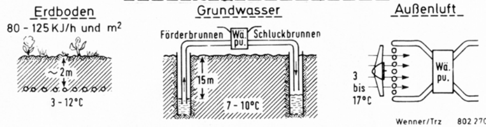
Abb. 17 Nutzung verfügbarer Wärmepotentiale
