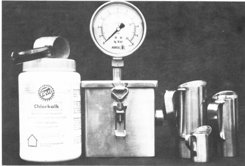
Abb. 1 Agros-Gerät zur Schnellbestimmung des pflanzenverfügbaren Stickstoffs in Gülle
