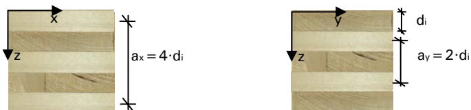
Abb. 5-10: Ermittlung a_x bzw. a_y einer Fünfschichtplatte
