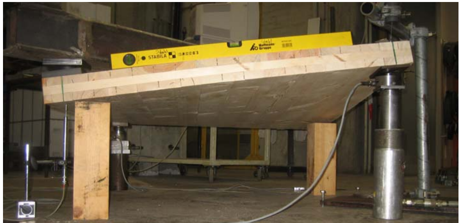
Abb. 5-79: Drill_3 81 im verformten Zustand, Holzklötze zum Schutz der Wegaufnehmer
