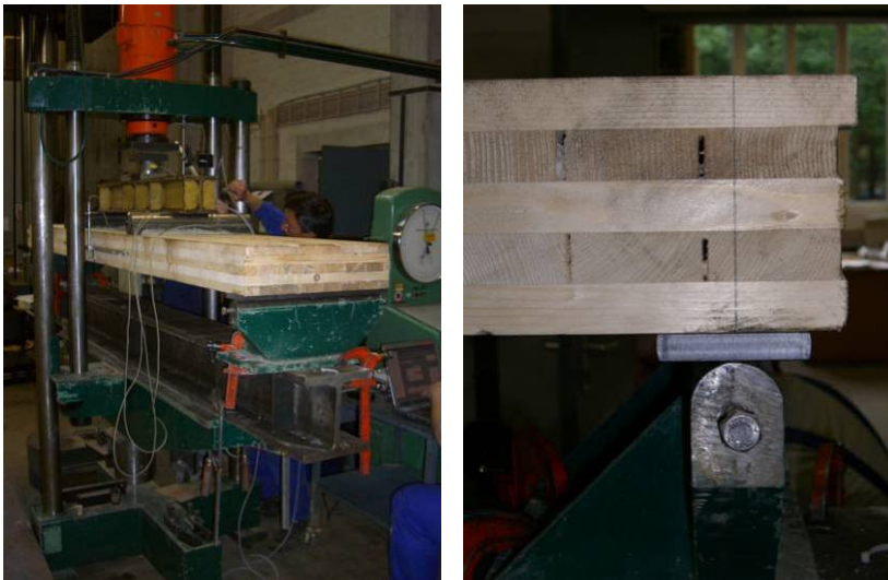
Abb. 5-86: Einbau der Prüfkörper und Auflagerdetail
