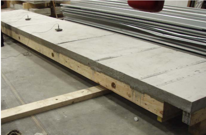
Abb. 6-27: Anordnung der Beschleunigungsaufnehmer
