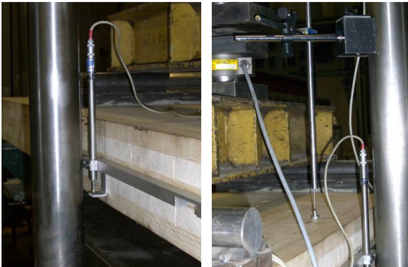
Abb. 5-87: Messbrücke für w_{rel} und Wegaufnehmer für Durchbiegung w in Feldmitte
