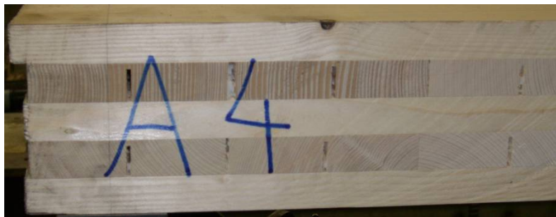
Abb. 5-84: Jahrringneigung der Starkholzlamellen
