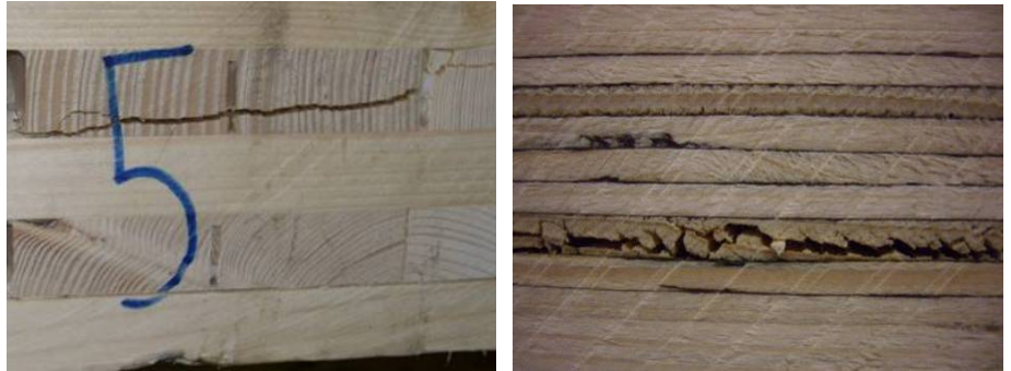
Abb. 5-88: Rollschubversagen in der Querlage bzw. in der quer verlaufenden Furnierschicht
