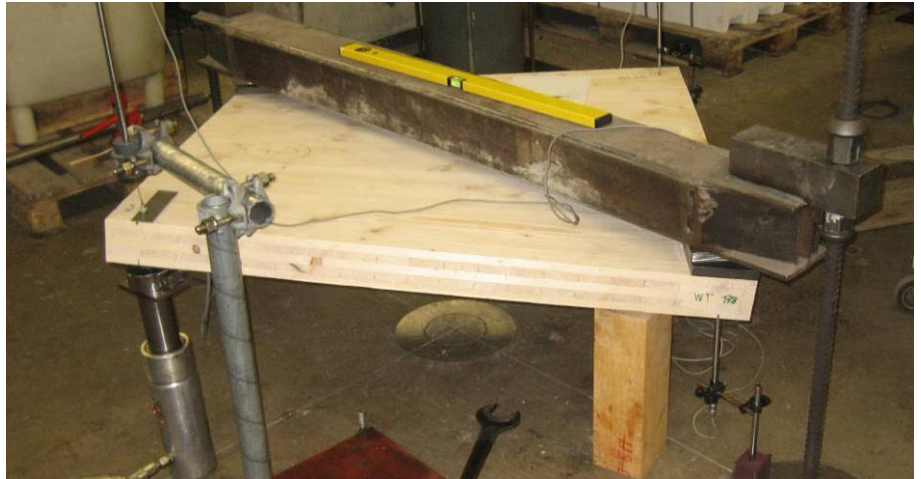
Abb. 5-78: Verdrillung des Prüfkörpers Drill_2 85
