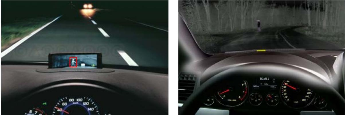
Abbildung 4–7: Warnendes FIR-NiVi mit Scheibenwurzeldisplay (links) (Honda, 2004) / Warnendes FIR-NiVi mit LED-Array (rechts) (Mahlke, et al., 2007)
