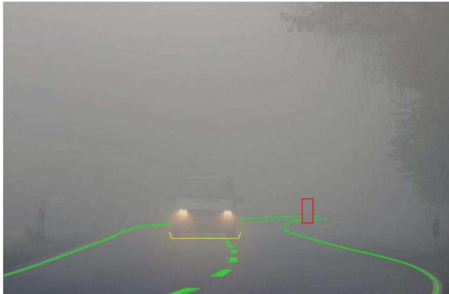
*Abbildung 7–2: Assistenzkonzept bei witterungsbedingter Sichtreduktion*
