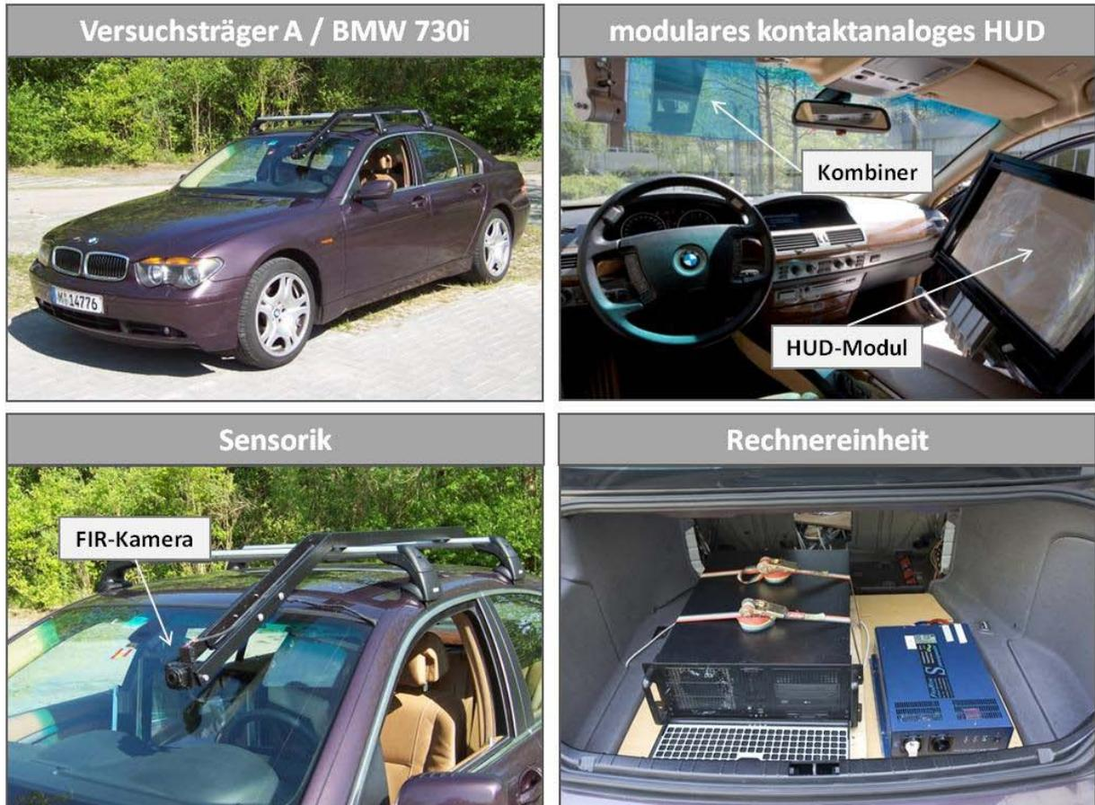
Abbildung 6–14: Versuchsträger A mit kontaktanalogem Head-Up-Display
