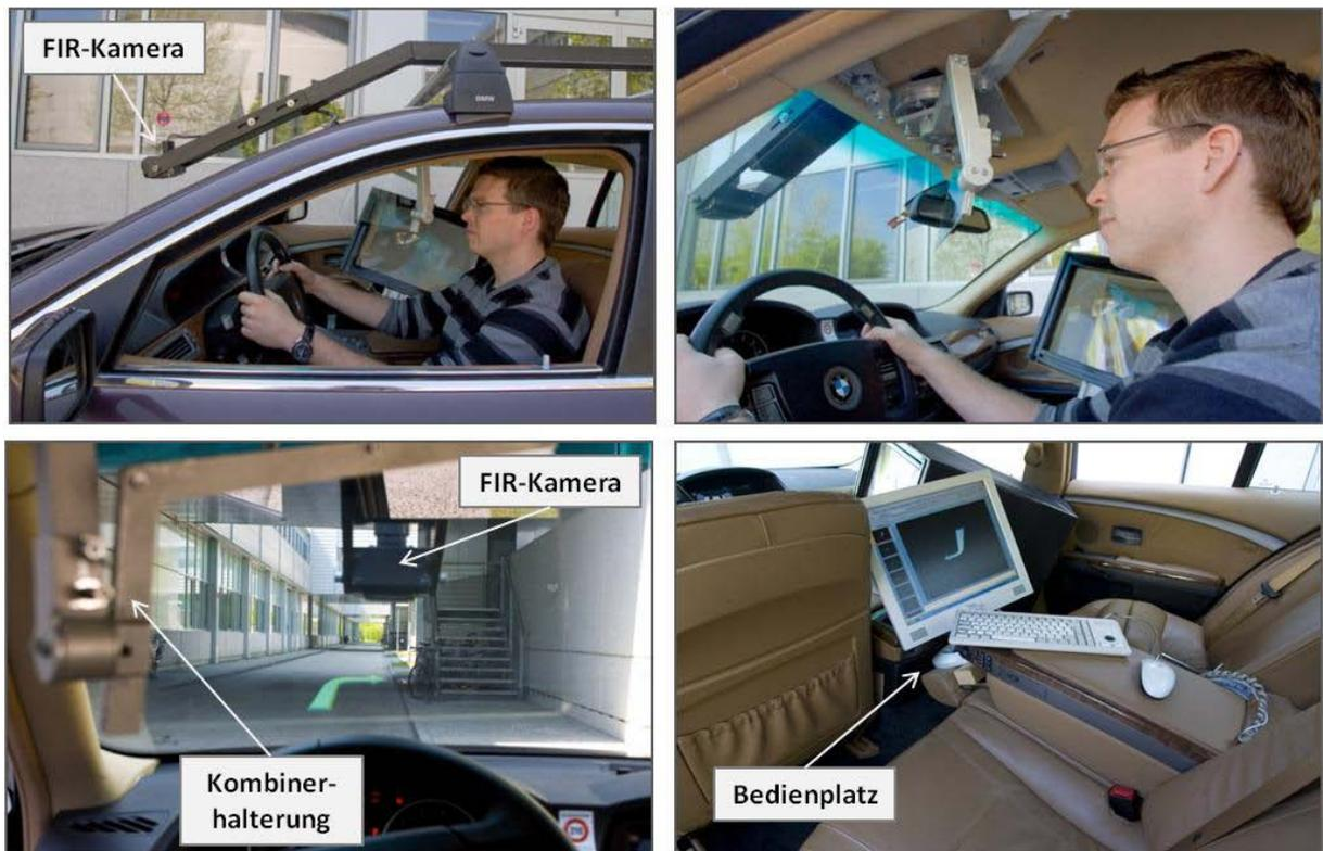
Abbildung 6–15: Anordnung der IR-Kamera, des Kombiners sowie des HUD-Moduls im Versuchsträger A
