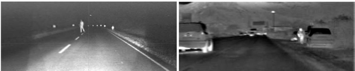
Abbildung 4–5: Videobild einer NIR-Sensorik (links) und einer FIR-Sensorik
