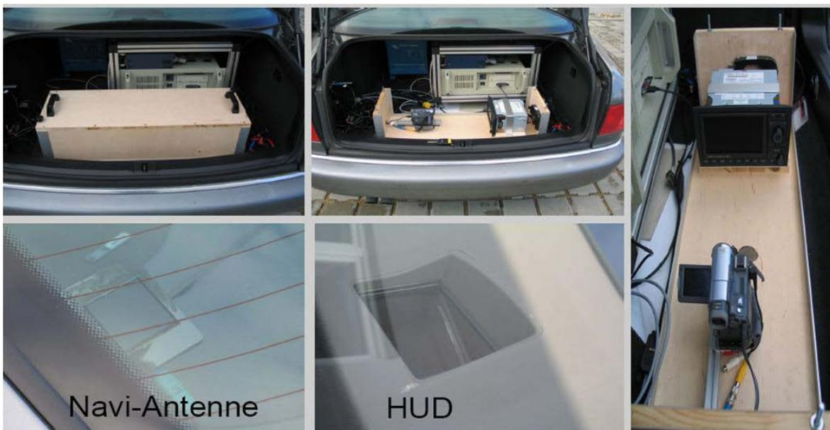
Abbildung 6–1: Versuchsträger der Bird-View-Anzeige
