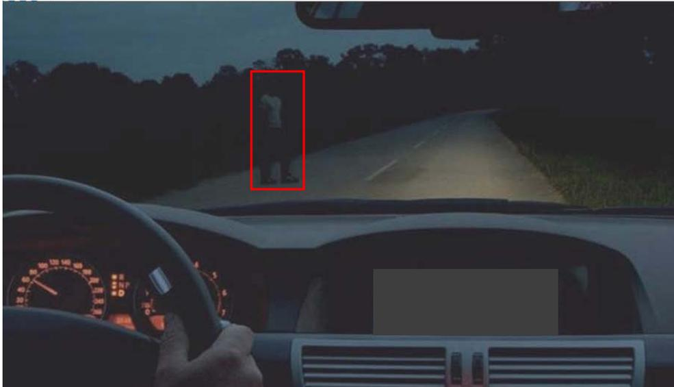
*Abbildung 5–3: Kontaktanaloge Markierung sicherheitskritischer Objekte im direkten Blickfeld des Fahrers*
