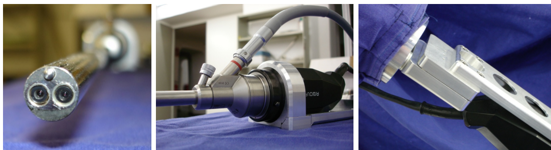
Abbildung 2.21: 3D-Endoskop und Adapterflansch
