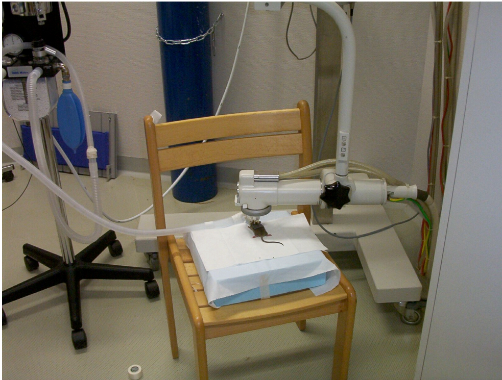
Abbildung 3: Bestrahlungsaufbau mit Narkosegerät
