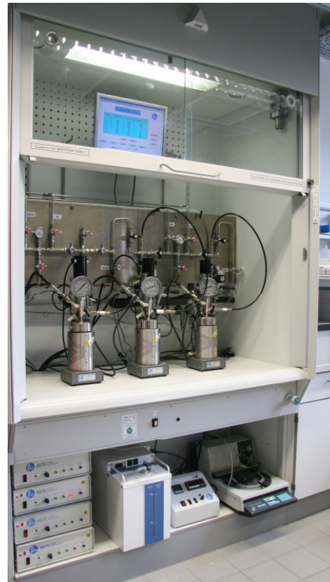
Abbildung 43. Autoklavenstände mit Gaszufuhr, Druckregler, Temperaturregler, Rührwerk.
