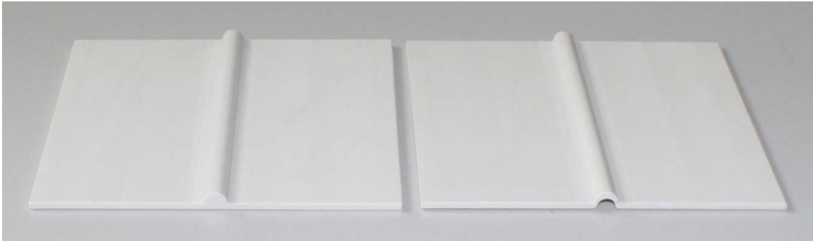
Abb. 7.9: Spanend hergestelltes Radom mit halbkreisförmiger Stegstruktur; links – ebene Rückseite; rechts – optimierte Rückseitenform
