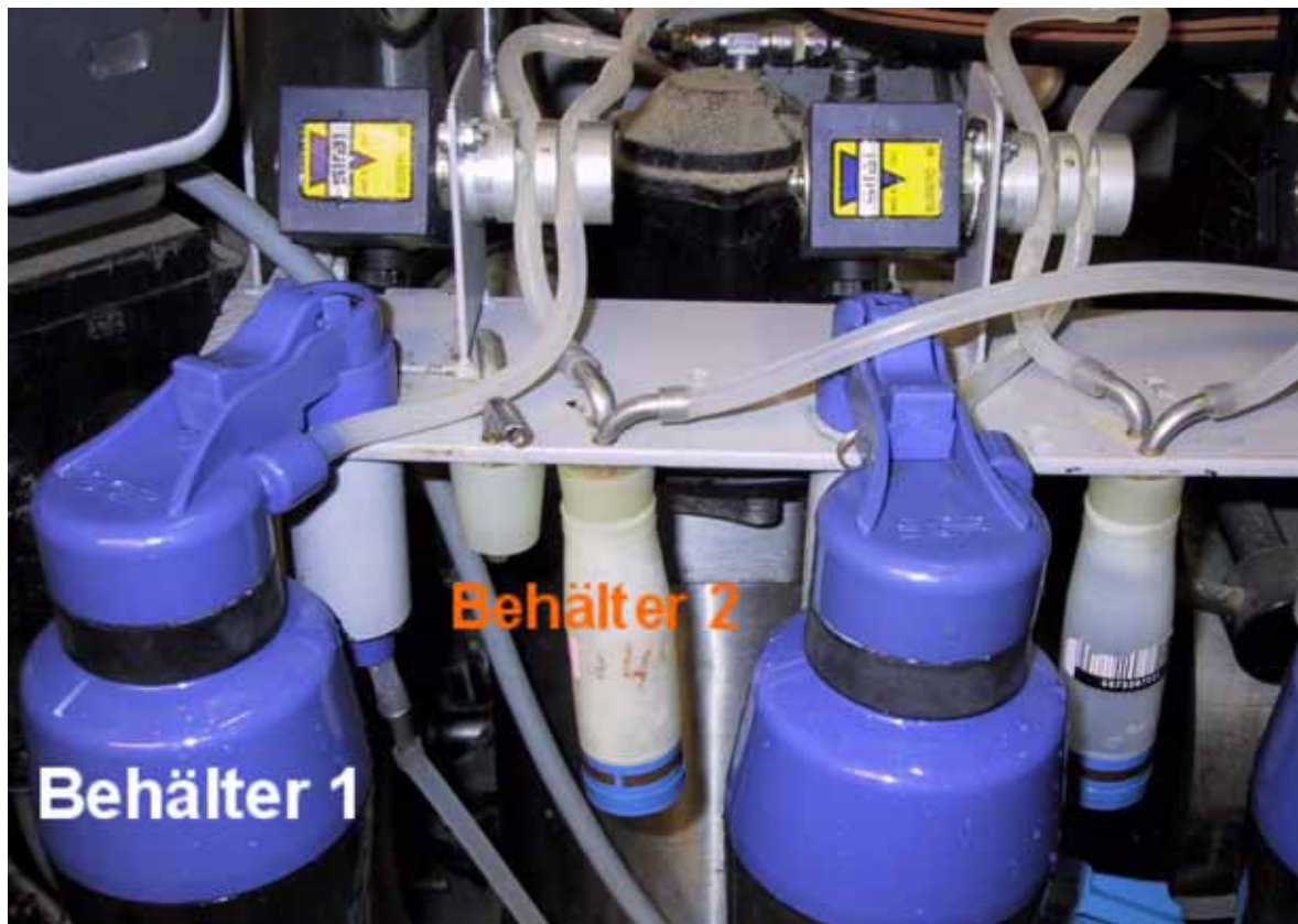
Abbildung 8: Detailansicht (2) der viertelspezifischen Probenahmevorrichtung: elektromagnetische Ventile zum Umleiten des Milchflusses in die zwei viertelspezifischen Behälter (1 und 2)
