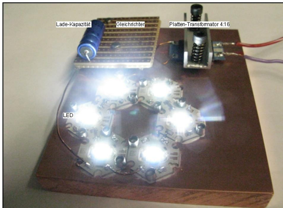
Abbildung 38: Demonstratorschaltung mit Platten-Transformator in der E16-Variante mit Windungsverhältnis  $N_{21} = 16/4$  und MnZn-Ferrit-Platten der Dicke  $d_f = 0.8\text{mm}$  bei einer Frequenz von  $f = 2.5\text{MHz}$ , Brücken-Gleichrichter Typ Diotec GBU 8D, Ladekapazität Typ SE, Leiterplatten Typ Rademacher 720 und sechs 15W-LEDs Ostar® Lightning LE UW E3A auf Kupferblock-Wärmesenke
