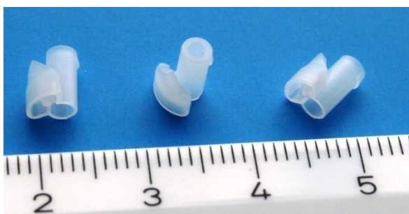
Abb. 59 Spannbolzenführung mit einem mittleren Bauteilgewicht von 43,52 mg
