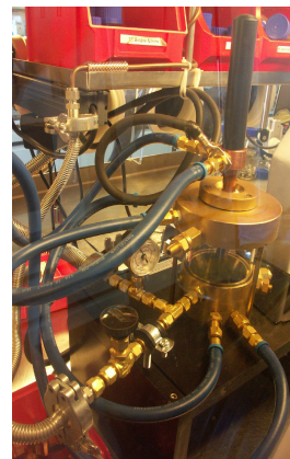
Abbildung 2.4: Lichtbogenofen im Innenraum einer mit Argon gefüllten Glove-Box mit externem Kühlwasseranschluss.
