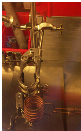
Abbildung 2.3: Hochfrequenzofen: Wassergekühlte Kupferwendel im Innenraum einer mit Argon gefüllten Glove-Box.
