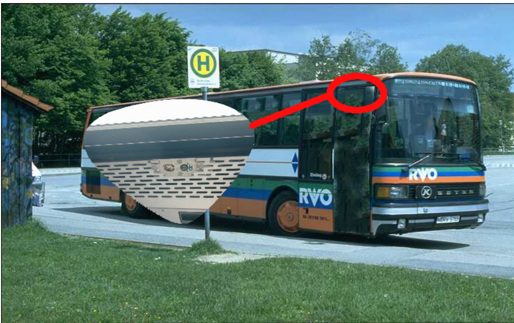
Abb. 7-6: Fahrzeug der RVO mit eingebautem aktiv-passiv Infrarotzählsystem
