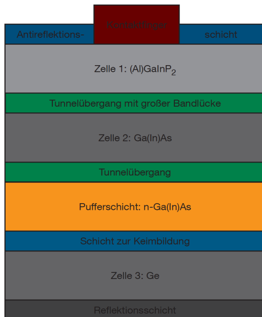
Abb. 1.7: „Multi-junction-Solarzelle auf III-V-Halbleiter und Germanium Basis. Grafik nach Literatur. 10
